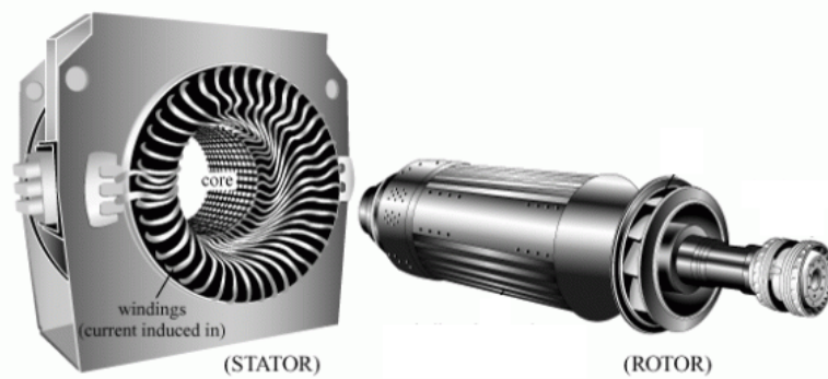
รูปที่ 2.7 เครื่องกำเนิดไฟฟ้า [23]
