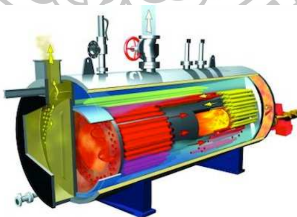
รูปที่ 2.1 หม้อไอน้ำแบบท่อไฟ (Fire tube boiler) [22]
