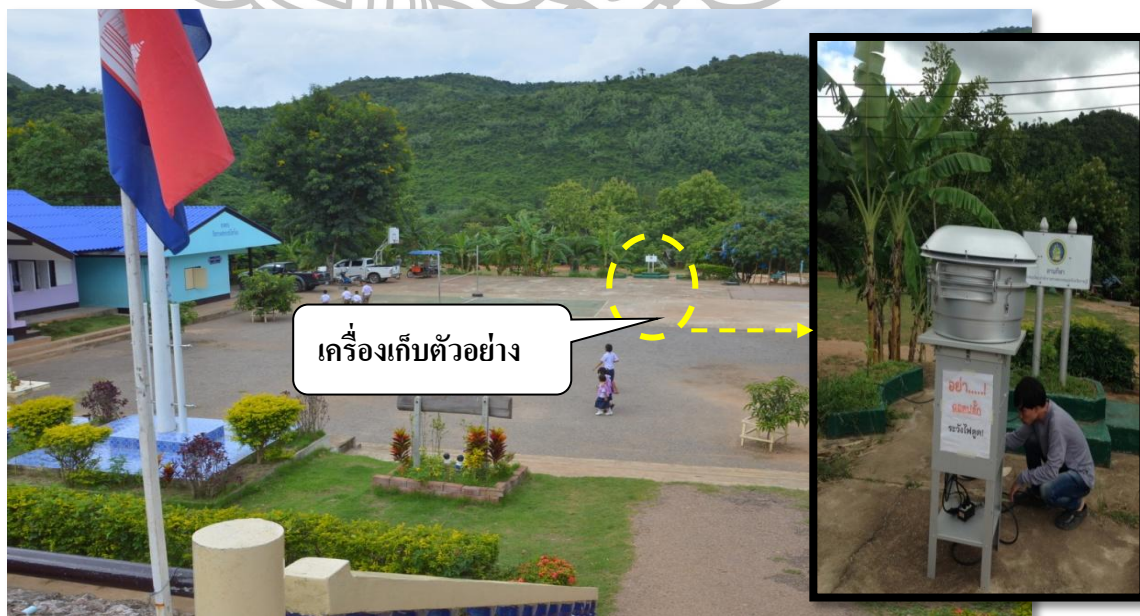
รูปที่ 3.7 จุดเก็บตัวอย่าง PM 10 ภายนอกอาคาร โรงเรียนตำรวจตระเวนชายแดนบ้านลำหิน อำเภอสวนผึ้ง จังหวัดราชบุรี
