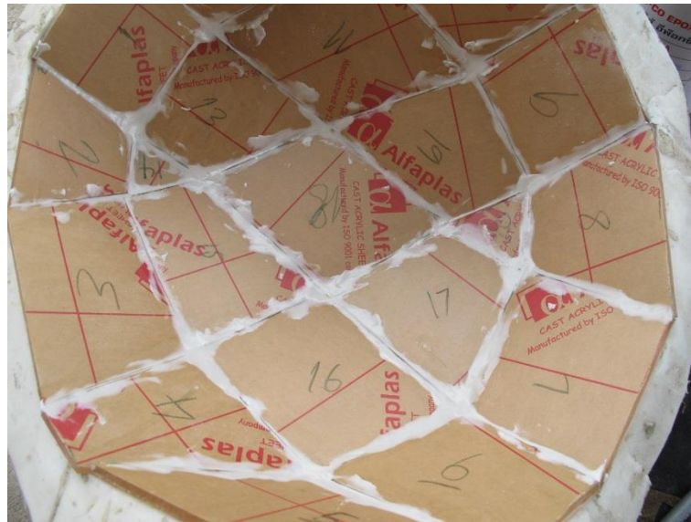
ภาพที่ 38 การประสานอะคริลิคด้วยน้ำยาประสาน และเพิ่มความแข็งแรงด้วยอีพ็อกซี
