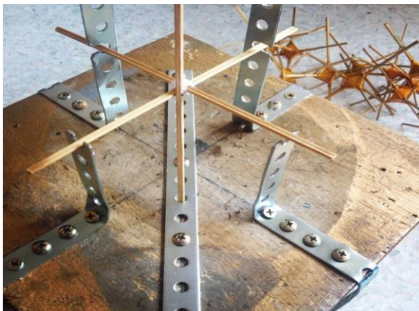
ภาพที่ 12 การขึ้นแกนด้วยเครื่องกำหนดระยะที่สร้างขึ้น ใช้กำหนดเส้นแกนให้มีความเอียงตามแบบร่างที่ต้องการ เมื่อนำหน่วยของตุ่งไปประกอบเป็น หน่วยใหญ่จะเส้นในแนวตั้งของรูปทรงเอียงได้ไปในทิศทางเดียวกัน
