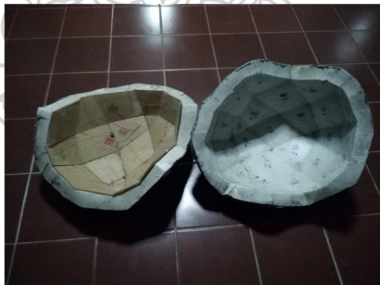
ภาพที่ 37 การประกอบอะคริลิกในแม่พิมพ์
