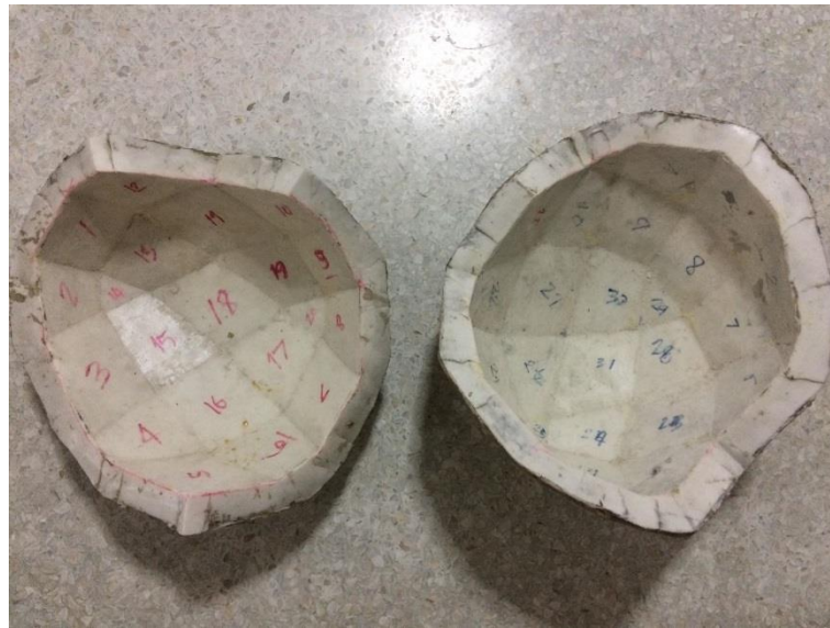
ภาพที่ 36 พิมพ์ซิลิโคน ทำพิมพ์และหล่อเพื่อที่จะได้แบบร่างมาแบ่งเป็นชิ้นส่วน เพื่อนำไปตัดอะคริลิกใสเพื่อนำไป ประกอบเป็นผลึกใส
