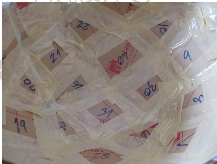
ภาพที่ 39 เพื่อป้องกันการยืดหยุ่นของชิ้นงานด้วยเทปกาว
