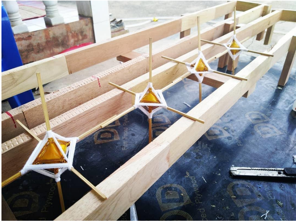
ภาพที่ 14 การประกอบหน่วยของตุ่งซี่ผึ้งเข้าด้วยกันด้วยให้เป็นเส้น
