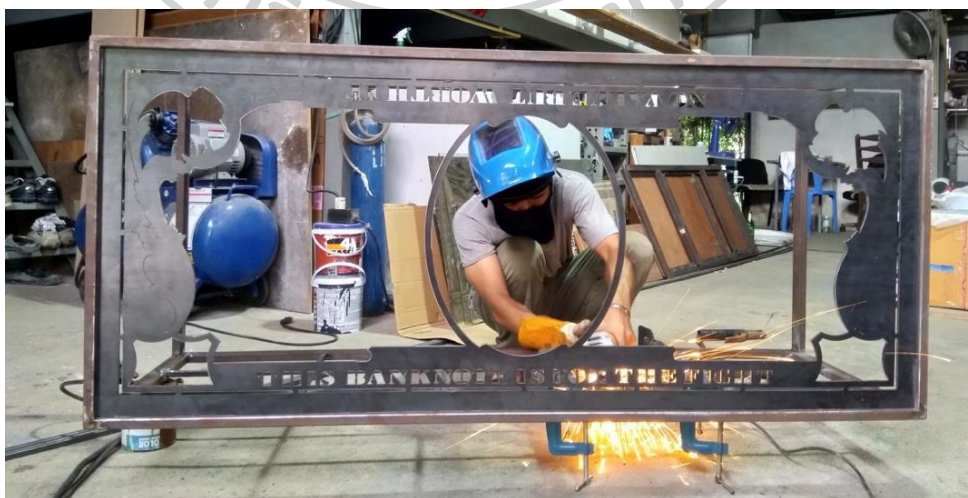
ภาพที่ 78 การเชื่อมประกอบในส่วน โลหะที่ตัดฉลุและขัดแต่งเก็บรายละเอียด
