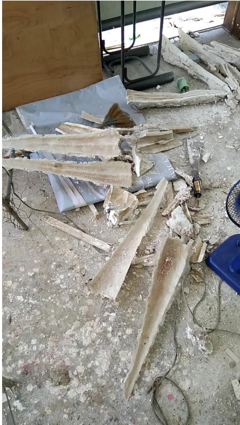
ภาพที่ 85 ชิ้นงานหลังจากการแกะปูนปลาสเตอร์ที่เป็นแม่พิมพ์ออก
