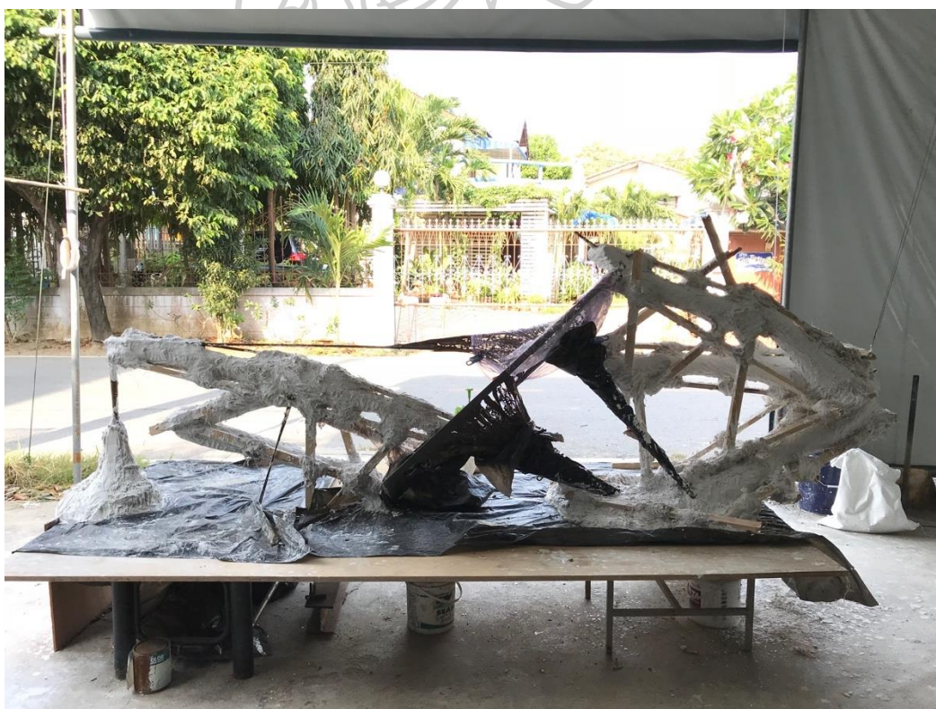
ภาพที่ 59 การเสริมโครงค้ำยันเพื่อสร้างความแข็งแรงของแม่พิมพ์
