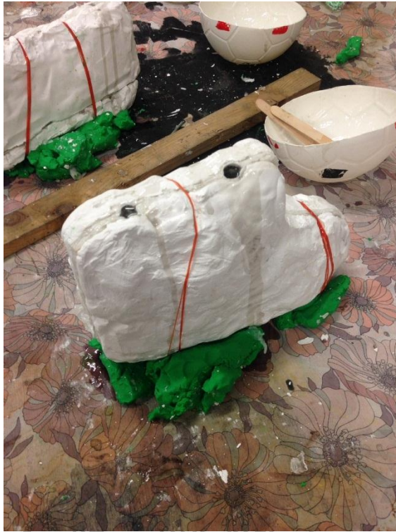
ภาพที่ 6 การประกบพิมพ์และเทพิมพ์สร้างวัตถุต้นแบบ
