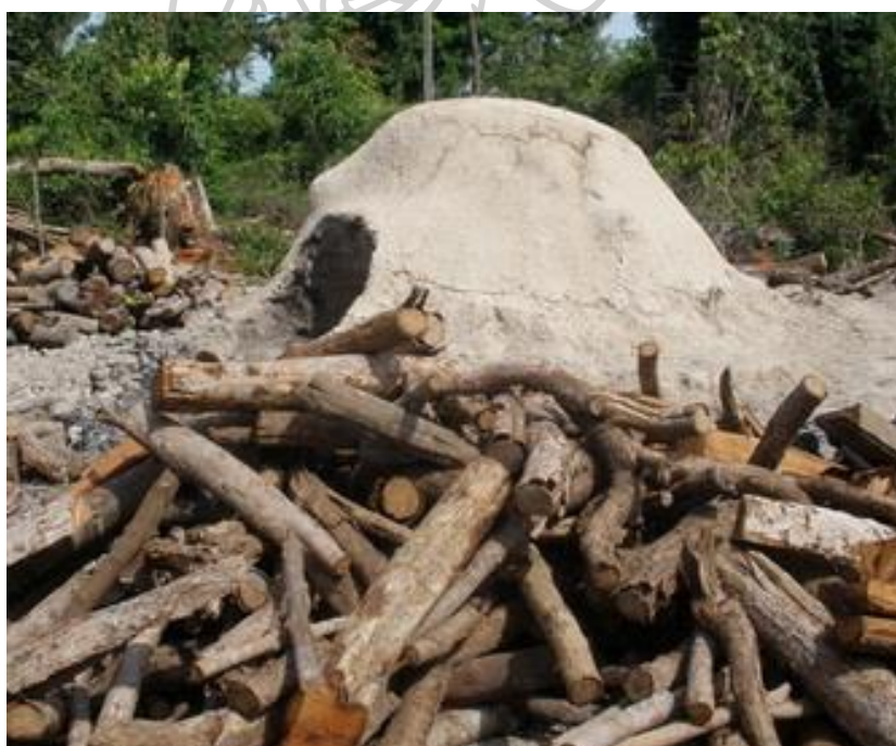
ภาพที่ 12 ภาพแสดงเตาเผาถ่าน ที่มา : เตาเผาถ่านพ่อ เข้าถึงเมื่อ 13 พ.ค. 2561 เข้าถึงได้จาก
