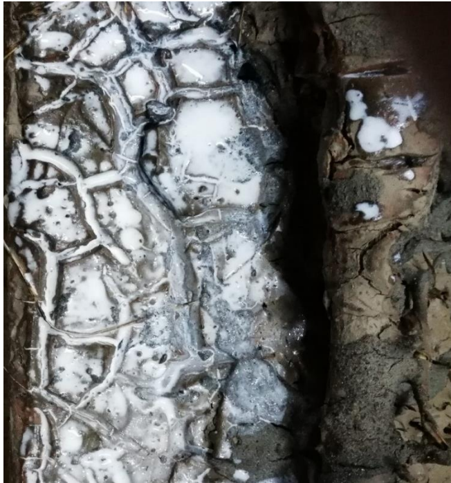
ภาพที่ 29 ภาพแสดงลักษณะการใช้แลกเกอร์เคลือบชิ้นงาน
