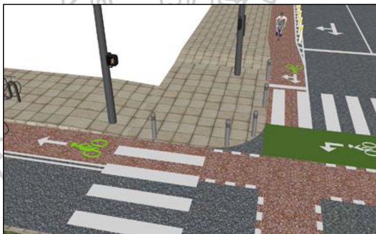
ภาพที่ 6 แสดงทางจักรยานสำหรับเลี้ยวซ้ายบริเวณทางแยก ที่มา : Ben Welle, and others.Cities Safer by Design: 2016,72.
