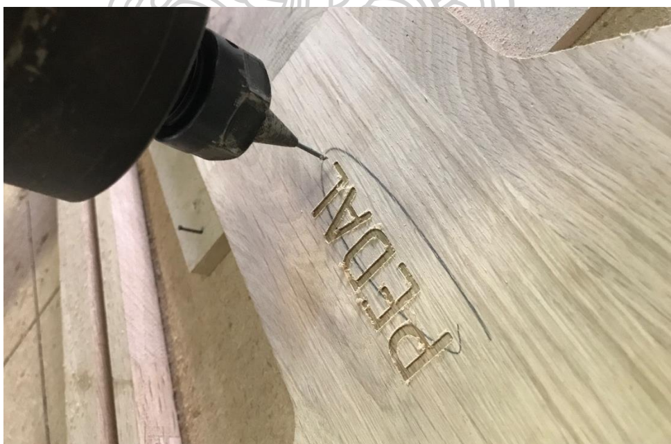
ภาพที่ 74 ผลิตชิ้นงานไม้ด้วยระบบ CNC
