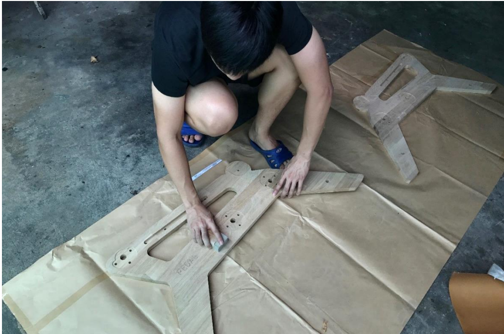
ภาพที่ 75 เก็บรายละเอียดชิ้นงานด้วยกระดาษทราย ที่มา: ถ่ายโดยผู้วิจัยเมื่อวันที่ 25 มิถุนายน 2561
