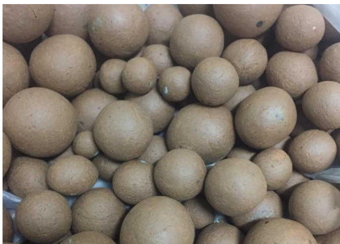
ภาพที่ 19 ดินเหนียวผสมดินทรายในอัตราส่วน 5 : 1 เเผาที่อุณหภูมิ 1000 องศาเซลเซียส ที่มาของภาพ : ถ่ายโดย ลลิตา สุนทรพุทธศาสตร์
