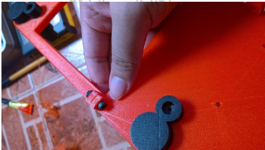
ภาพที่ 71 การต่อแผ่นรองฐานตัวเครื่องที่มีขนาดใหญ่
