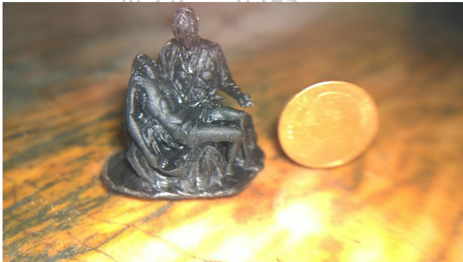
ภาพที่ 48 ชิ้นงานที่พิมพ์ด้วยเครื่องแบบ Chimera 1
