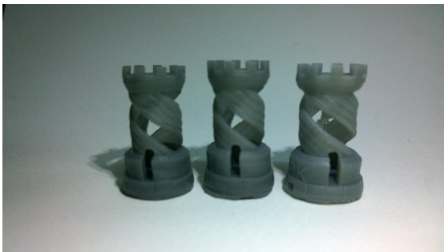
ภาพที่ 51 ชิ้นงานที่พิมพ์จากการตั้งค่า 1 2 และ 3 ตามลำดับ ถ่ายภาพโดย เซษฐชาติ ทาชาติ
