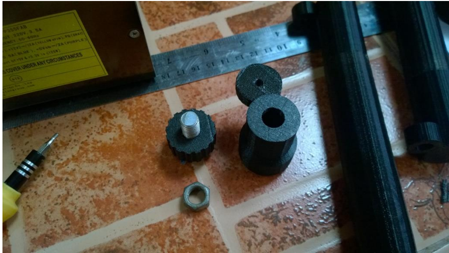
ภาพที่ 70 ขาแบบปรับความสูงได้ของการออกแบบเครื่องครั้งที่ 1
