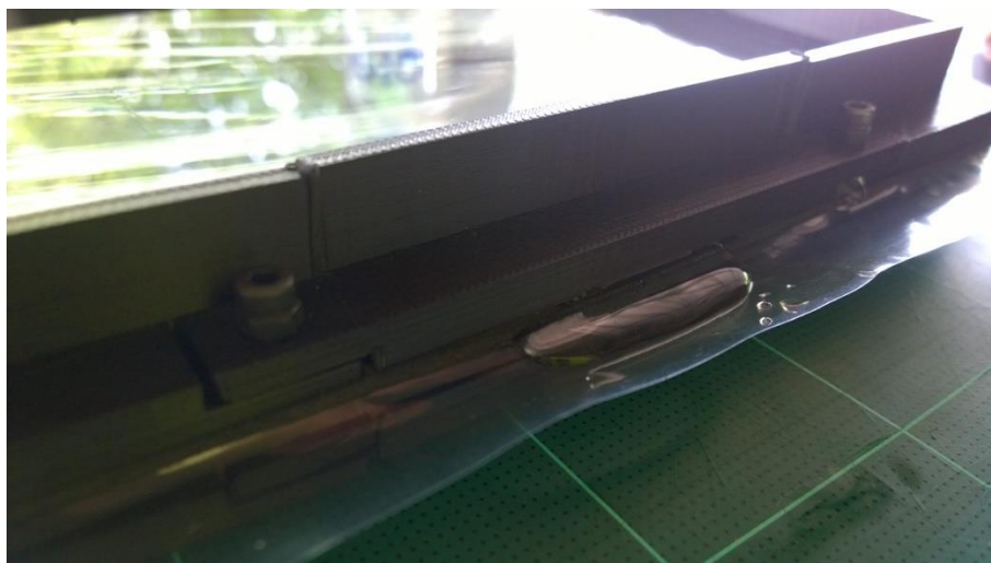
ภาพที่ 28 การรื้อซึมเนื่องจากการแนบกันไม่สนิทของชิ้นส่วน ถ่ายภาพโดย เชษฐชาติ ทาชาติ
