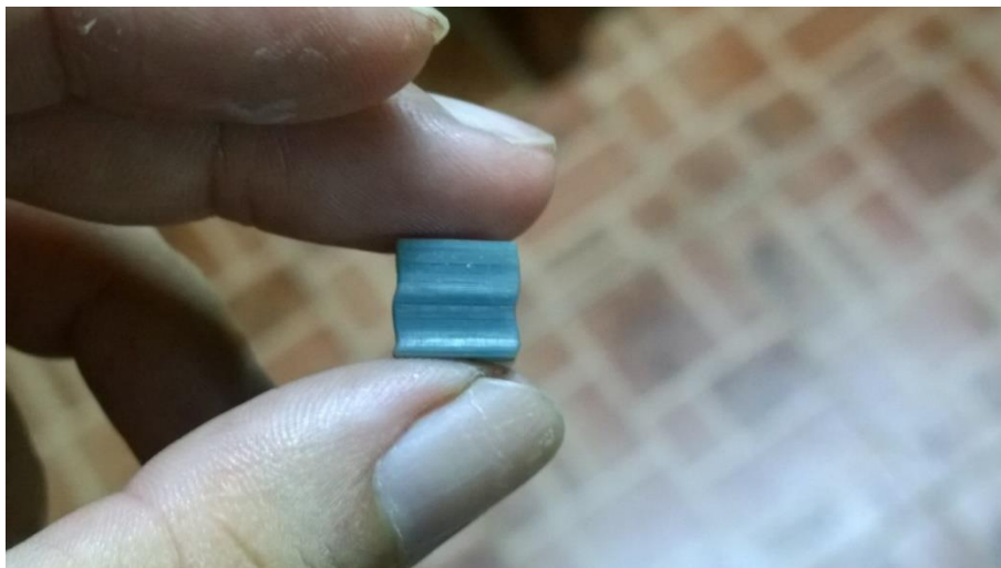
ภาพที่ 32 ลอนคลื่นจากการขยับไปมาของโครงสร้างแกนเคลื่อนที่ ถ่ายภาพโดย เชษฐชาติ ทาชาติ
