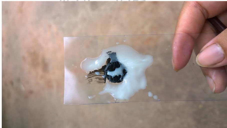
ภาพที่ 58 ทดสอบการติดระหว่างเรซินและซิลิโคน
