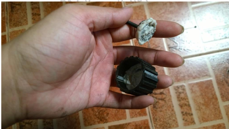
ภาพที่ 73 ชิ้นส่วนที่เสียหายจากแรงบิด
