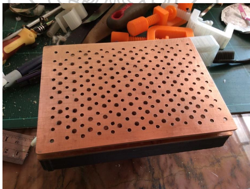
ภาพที่ 27 เจาะรูที่ฐานพิมพ์ เพื่อแก้ปัญหาการพิมพ์ไม่ติดฐาน ถ่ายภาพโดย เชษฐชาติ ทาชาติ
