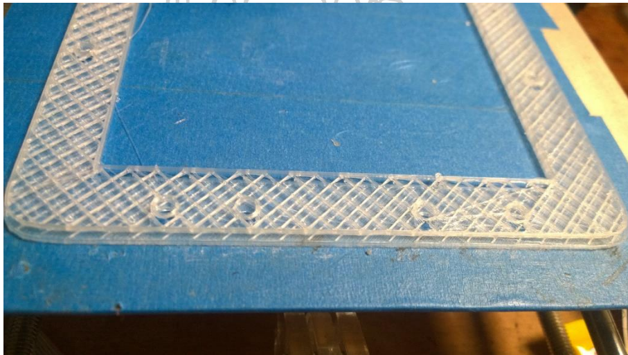
ภาพที่ 60 ชิ้นส่วนที่พิมพ์ไม่สมบูรณ์เนื่องจากโมเดลมีปัญหา
