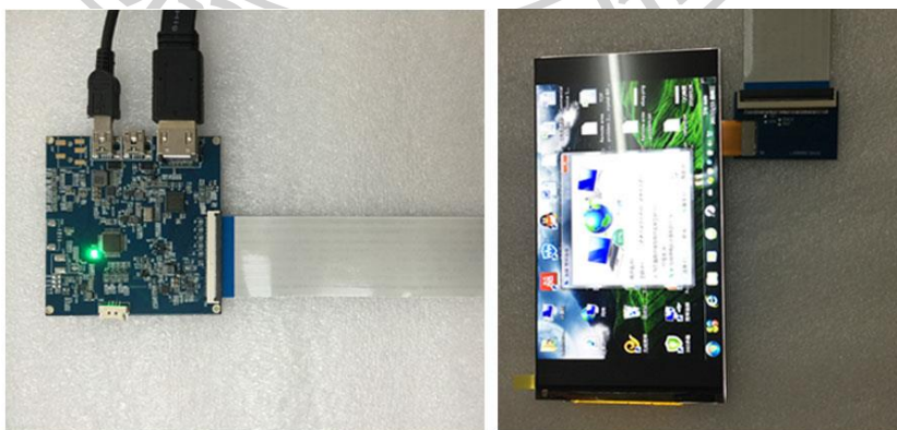
ภาพที่ 8 (ซ้าย) ส่วนควบคุมการแสดงผล, (ขวา) LCD
