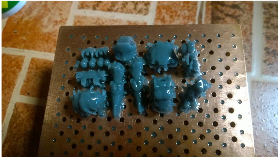
ภาพที่ 76 ชิ้นงานที่พิมพ์ทดสอบ พบปัญหาที่แกน Z
