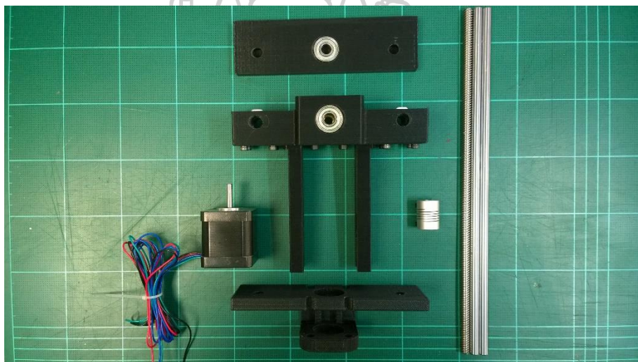
ภาพที่ 56 ชิ้นส่วนของแกนเคลื่อนที่แนวตั้ง และตัวยึดแทนพิมพ์
