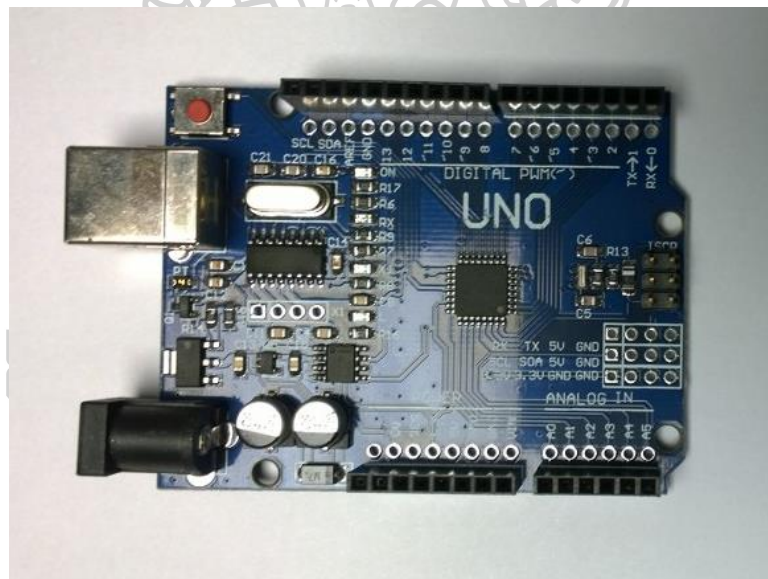
ภาพที่ 11 ไมโครคอนโทรลเลอร์ Arduino Uno ถ่ายภาพโดย เชษฐชาติ ทาชาติ
