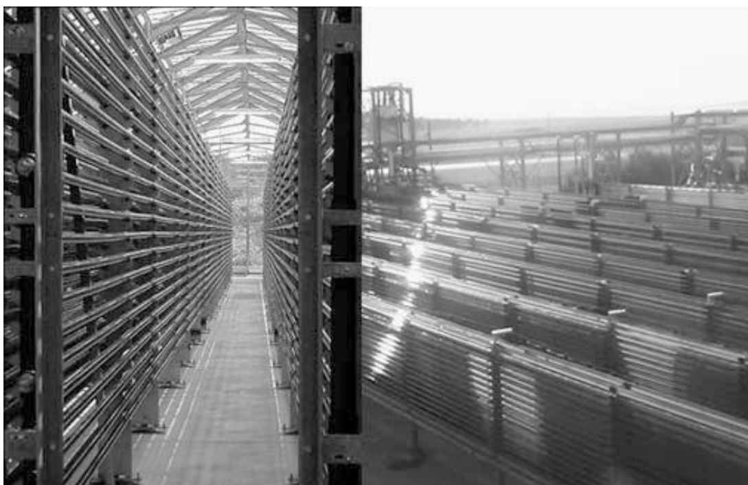
ภาพที่ 5 การเลี้ยงในระบบปิดเชิงพาณิชย์ใน tubular photobioreactor
