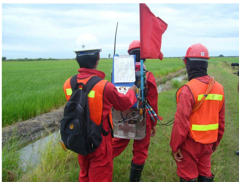
รูปที่ 11 การวางแหล่งกำเนิดคลื่นของการวัดคลื่นไหวสะเทือน 3 มิติ
