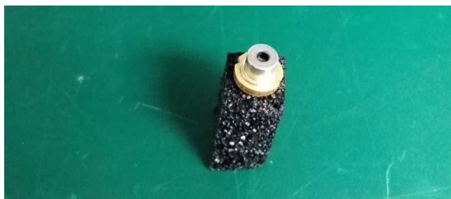
รูปที่ 3.19 เลเซอร์ไดโอด รุ่น VPSL-0635-005X-5-A ผลิตโดยบริษัท Blue Sky Research
