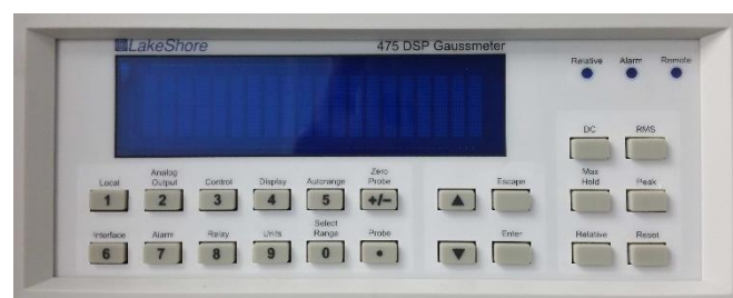
รูปที่ 3.5 เกาส์มิเตอร์กรุ่น Model 475 ผลิตโดยบริษัท lakeshore
