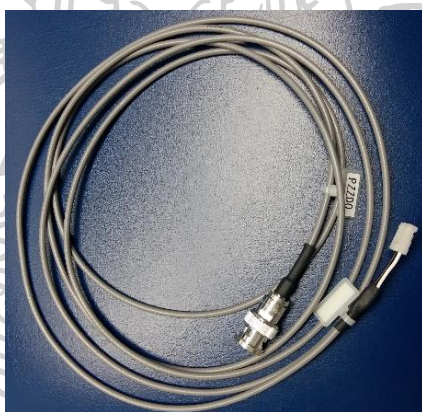
รูปที่ 3.18 สายส่งสัญญาณที่ออกแบบเพื่อใช้กับเพียโซอิเล็กทริก
