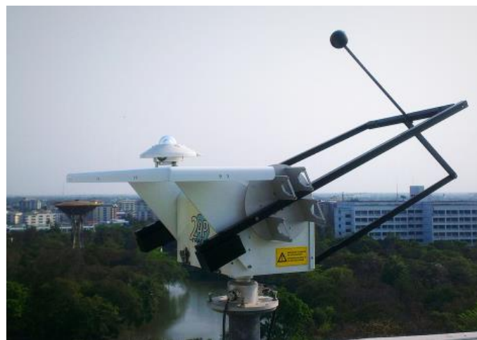
รูปที่ 2.9 เครื่องวัดสเปกตรัมรังสีกระจายที่มีลูกบอลบังรังสีตรงของดวงอาทิตย์ซึ่งติดตั้งอยู่กับเครื่องติดตามดวงอาทิตย์ (sun tracker)
