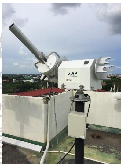
รูปที่ 2.7 เครื่องวัดสเปกตรัมรังสีอาทิตย์ตรงซึ่งติดตั้งอยู่กับเครื่องติดตามดวงอาทิตย์ (sun tracker)
