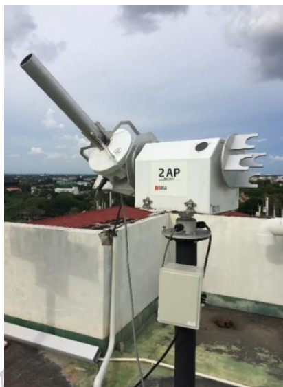
รูปที่ 3.1 เครื่องวัดสเปกตรัมรังสีอาทิตย์ตรง EKO spectroradiometer (MS-710) ซึ่งติดอยู่กับเครื่องติดตามดวงอาทิตย์ Kipp & Zonen (Model 2AP)
