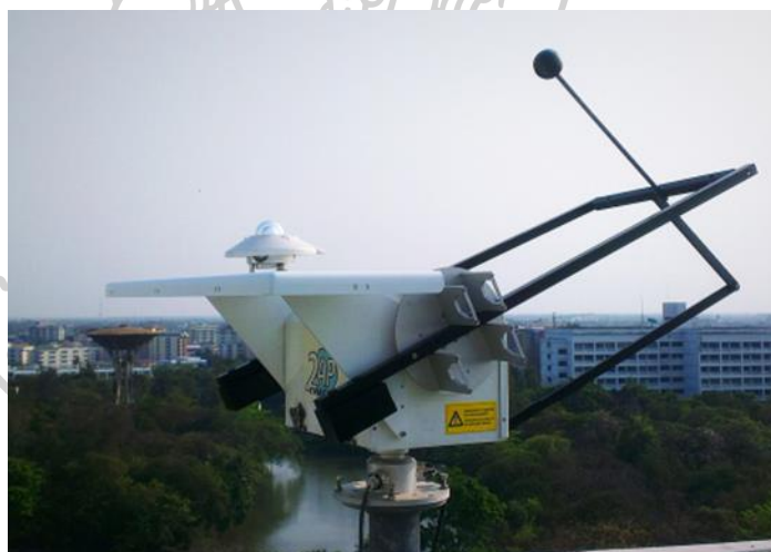
รูปที่ 3.2 เครื่องวัดสเปกตรัมรังสีกระจาย EKO spectroradiometer (MS-710) ที่มีลูกบอลบังรังสีตรงของดวงอาทิตย์ซึ่งติดอยู่กับเครื่องติดตามดวงอาทิตย์ Kipp & Zonen (Model 2AP)
