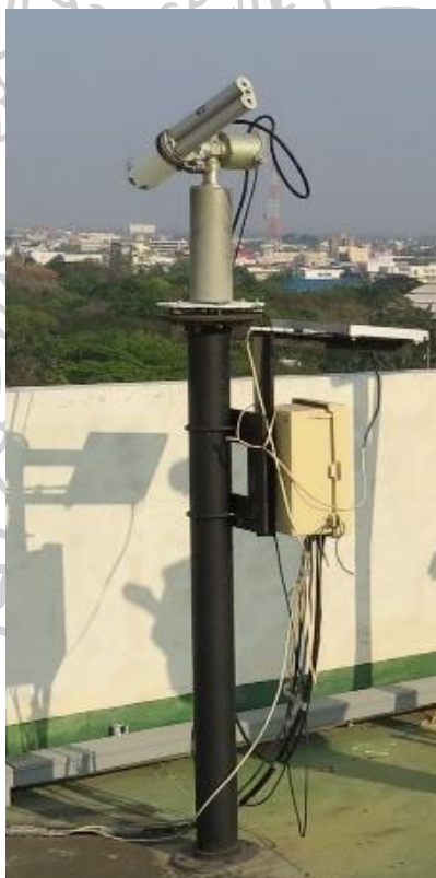
รูปที่ 3.24 เครื่อง cimel sunphotometer ซึ่งติดตั้งที่มหาวิทยาลัยศิลปากร จังหวัดนครปฐม
