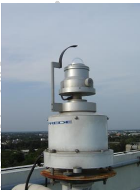
รูปที่ 3.27 กล้องถ่ายภาพท้องฟ้าอัตโนมัติซึ่งติดตั้งที่มหาวิทยาลัยศิลปากร จังหวัดนครปฐม
