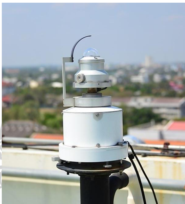
รูปที่ 3.5 เครื่องถ่ายภาพท้องฟ้า (sky view) ซึ่งติดตั้งที่คณะวิทยาศาสตร์ มหาวิทยาลัยศิลปากร จังหวัดนครปฐม
