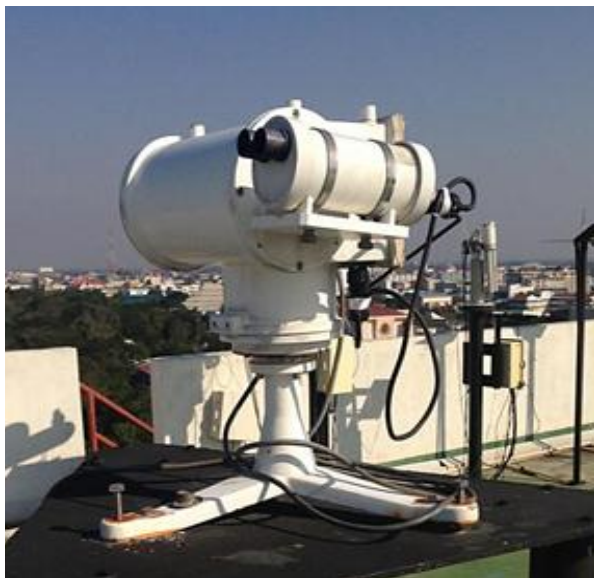
รูปที่ 3.1 เครื่อง sky scanner ของบริษัท EKO รุ่น MS - 321LR ซึ่งติดตั้งที่คณะ วิทยาศาสตร์มหาวิทยาลัยศิลปากร จังหวัดนครปฐม
