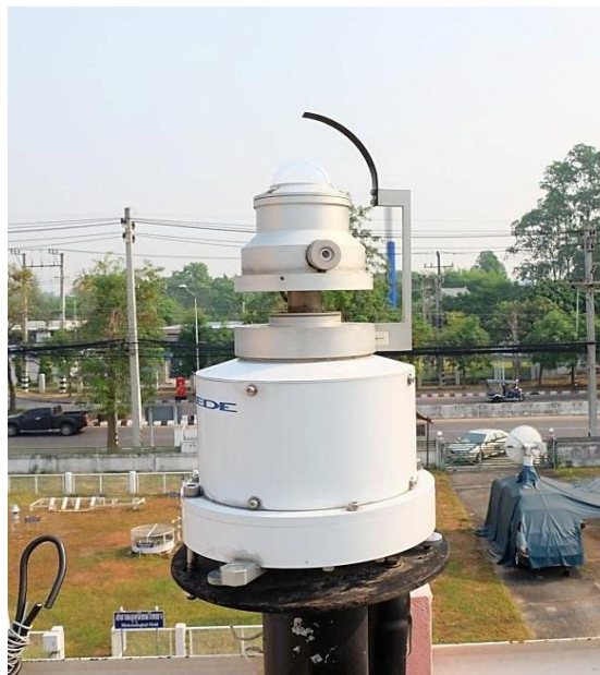
รูปที่ 3.6 เครื่องถ่ายภาพท้องฟ้า (sky view) ซึ่งติดตั้งที่ศูนย์อุตุนิยมวิทยาภาคเหนือจังหวัดเชียงใหม่
