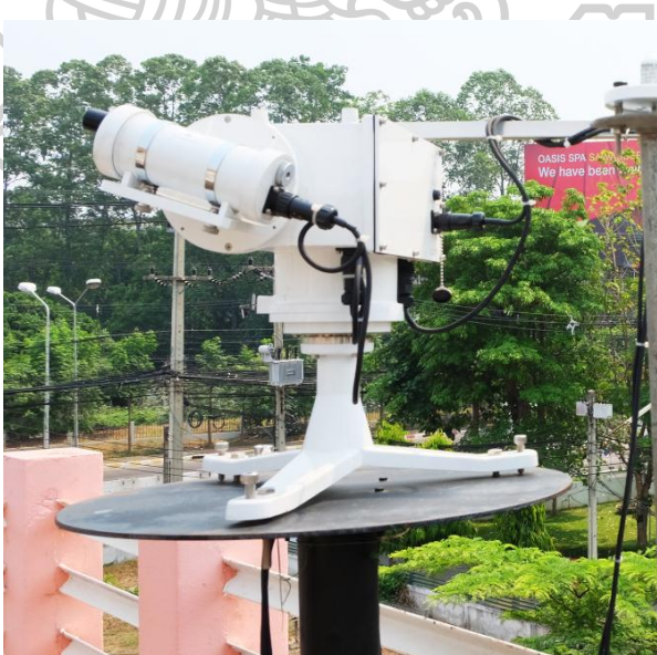
รูปที่ 3.2 เครื่อง sky scanner ของบริษัท EKO รุ่น MS - 321LR ซึ่งติดตั้งที่ศูนย์ อุตุนิยมวิทยาภาคเหนือ จังหวัดเชียงใหม่
