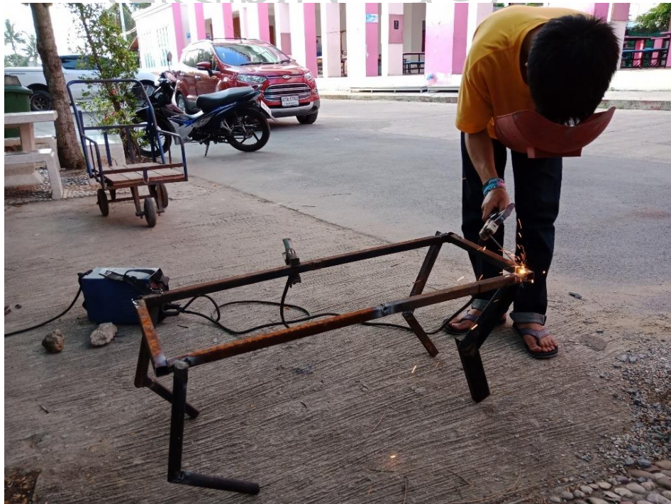
ภาพที่ 93 ภาพการเชื่อมเศษเหล็กขึ้นเป็นขาตั้งให้มีลักษณะโครงสร้างของขาตั้งคล้ายกับขาสุนัข
