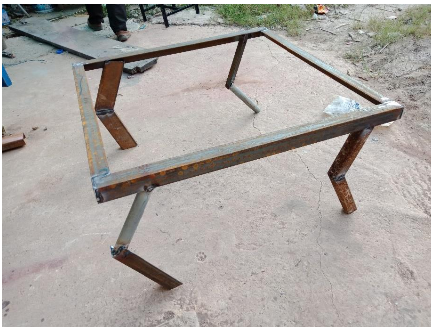
ภาพที่ 69 ภาพขาตั้งที่เชื่อมให้มีลักษณะโครงสร้างขาตั้งมาจากขาของสุนัข
