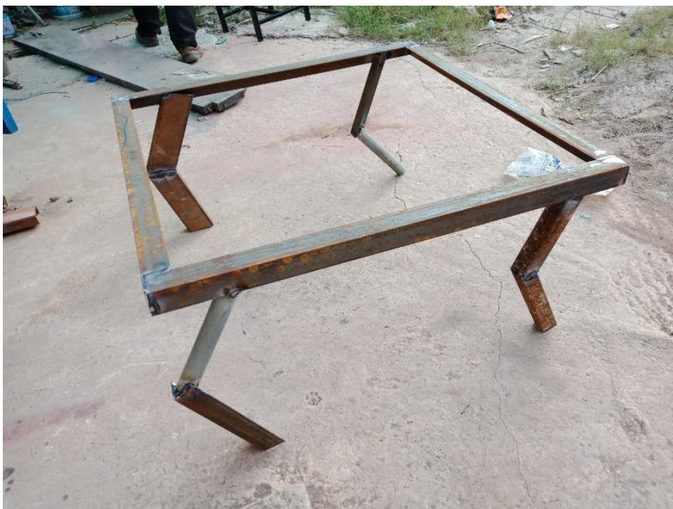
ภาพที่ 42 ภาพเหล็กขาตั้งที่เชื่อมขึ้นแล้ว
