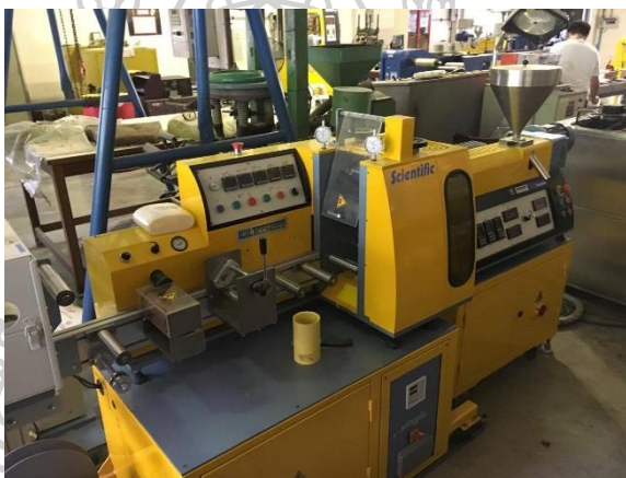
ภาพที่ 3.9 เครื่องหลอมอัดรีดแผ่นฟิล์ม (Cast film extruder)
