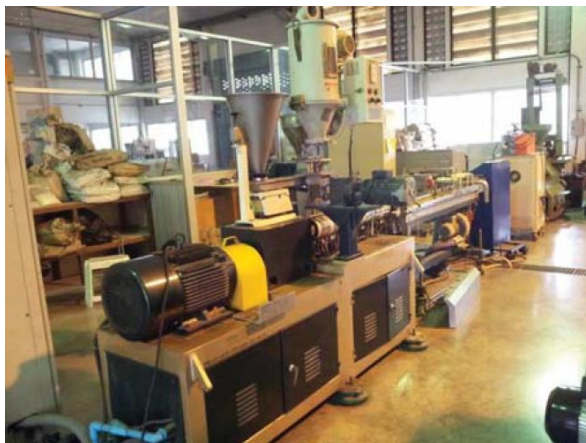
ภาพที่ 3.7 กระบวนการหลอมผสมด้วยเครื่องอัดรีดแบบสกรูคู่
