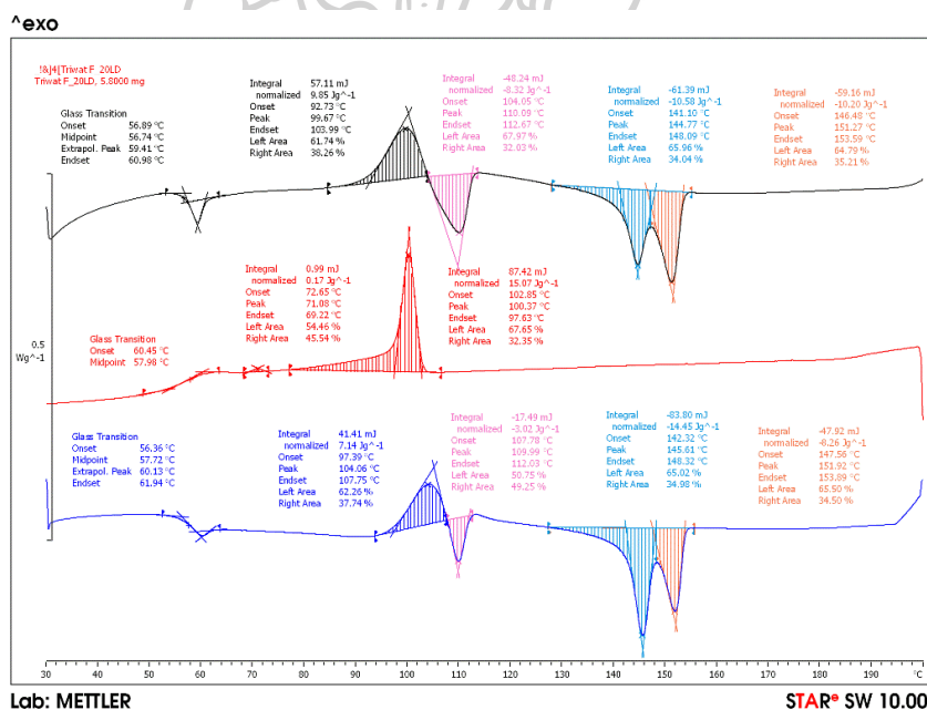
ภาพที่ ก-3 DSC thermogram ในขั้นตอน heat-cool-heat ของ PLA/LDPE (80/20) (heating rate: 3 °C/min)
