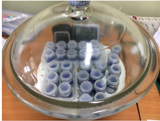
ภาพที่ 3.16 ขวดแก้วที่ปิดปากฟิล์มด้วย paraffin film และนำไปไว้ใน desiccator
