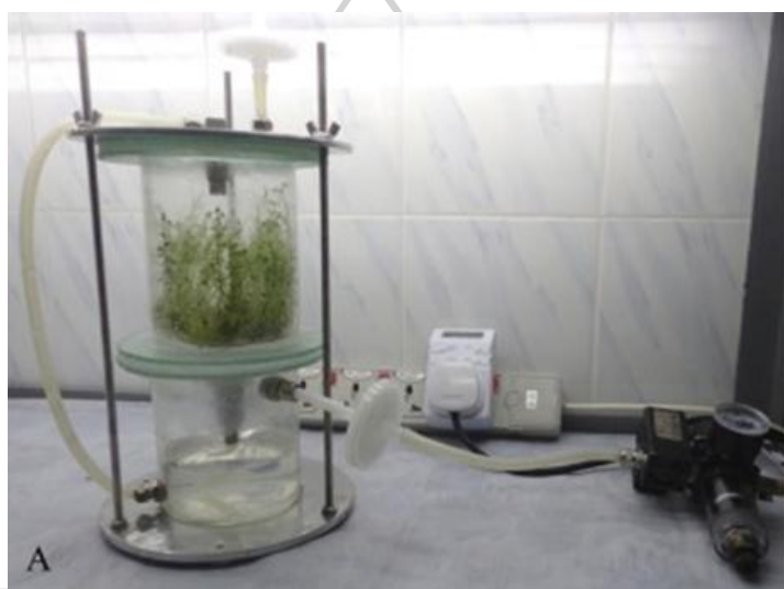
ภาพที่ 12 ระบบถังปฏิกรณ์ชีวภาพแบบพ่นฝอย (NSB)
