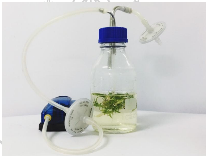
ภาพที่ 26 ระบบอาหารเหลวที่มีการพ่นอากาศอย่างง่าย
