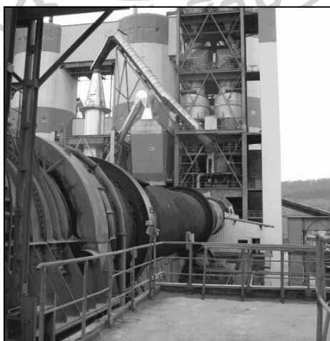
รูปที่ 2.10 เตาเผาแบบแห้งชนิดสั้น ( Short Dry Kilns ) ที่มา “Rotary Kilns transport phenomena and transport processes”
