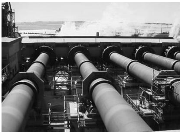
รูปที่ 2.9 เตาเผาแบบแห้งชนิดยาว ( Long Dry Kilns) ที่มา “Rotary Kilns transport phenomena and transport processes”
