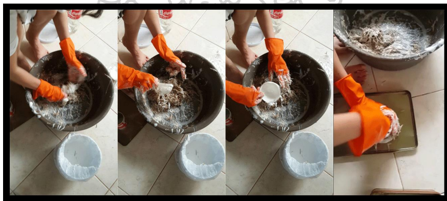
ภาพที่ 50 การขึ้นรูปแบบอัดกับกาว
