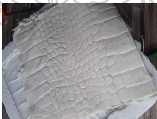
ภาพที่ 42 ทดลองหล่อตามสัดส่วนสี 1:100 หนังเทียมที่ได้จะยังคงเห็นลายผ้าของผ้าฝักตบชวาชัดเจน ที่มา : โดยผู้วิจัย ประกายทิพย์ ทองเหลือ
