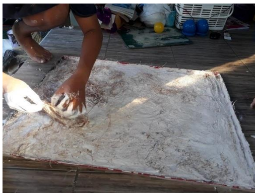
ภาพที่ 32 ทำแม่พิมพ์ปูนปลาสเตอร์ผสมยิมะพร้าว
