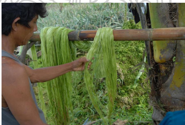
ภาพที่ 20 นำใบสับปะรดมาแปรรูปเข้าเครื่องรีดที่เป็นเส้นใยแล้วนำมาตาก
