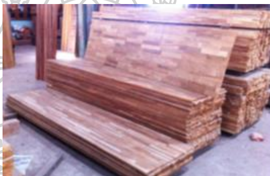
ภาพที่ 34 ภาพแสดงไม้ประสานที่เป็นรูปแบบแผ่น
