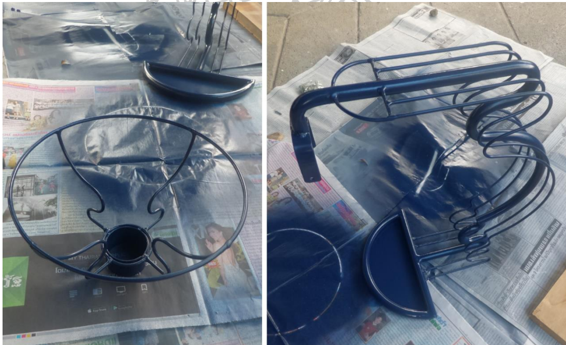
ภาพที่ 58 การทำสีและเคลือบด้านชิ้นงานต้นแบบ ที่มา : ถ่ายโดย ระพีพร เปี่ยมระลึก เมื่อวันที่ 5 ตุลาคม 2561
