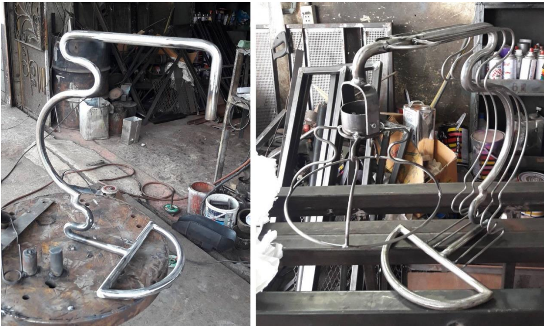
ภาพที่ 57 การขึ้นโครงชิ้นงานจากท่อเหล็กหล่อเหนียวและเหล็กเส้น ที่มา : ถ่ายโดย ระพีพร เปี่ยมระลึก เมื่อวันที่ 4 ตุลาคม 2561
