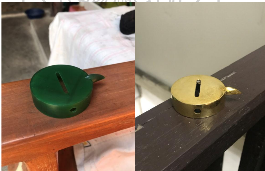
ภาพที่ 86 การหล่อขึ้นรูปฝาหยอดเงิน
