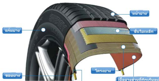
ภาพที่ 2 ความรู้ทั่วไปเกี่ยวกับยางรถยนต์
