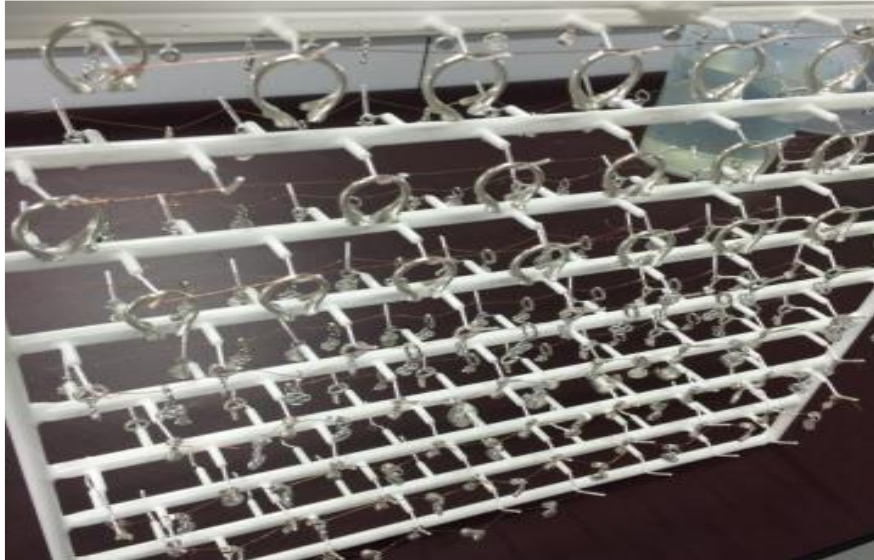
ภาพที่ 10 แสดงการแขวนตัวเรือนโลหะด้วยลวดทองแดงเพื่อเตรียมสำหรับการชุบ
