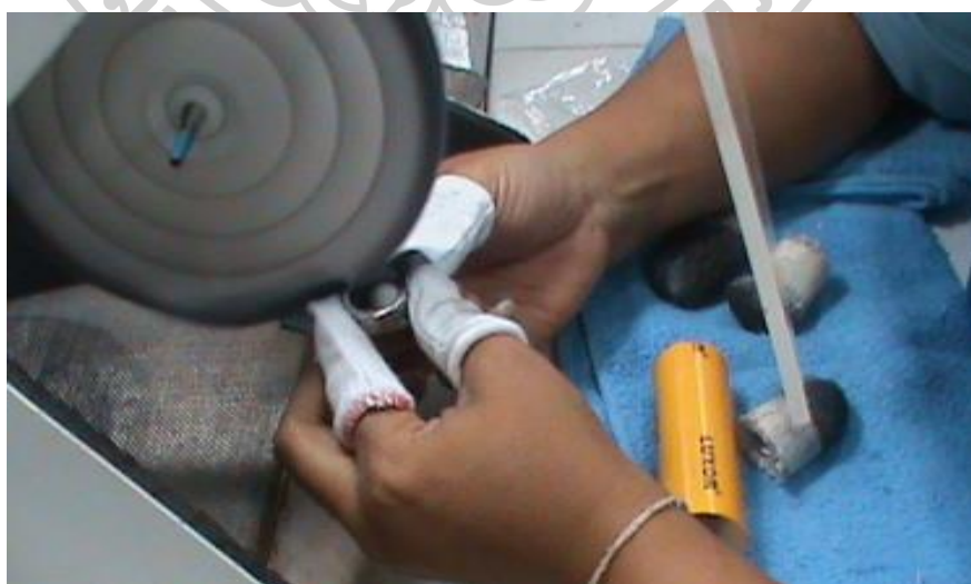
ภาพที่ 9 แสดงการขัดเงาตัวเรือนโลหะ
