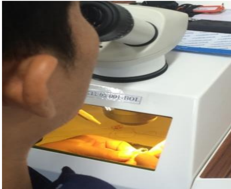
ภาพที่ 6 แสดงการเชื่อมส่วนประกอบของตัวเรือนโดยเครื่องเชื่อมเลเซอร์
