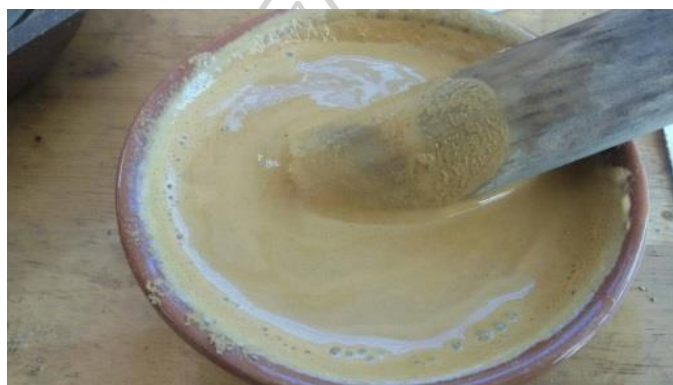
ภาพที่ 50 ในส่วนหินทรายที่มีความหนาแน่นปานกลางถึงความหนาแน่นน้อยก็สามารใช้โม่บดด้วยไม้ได้
