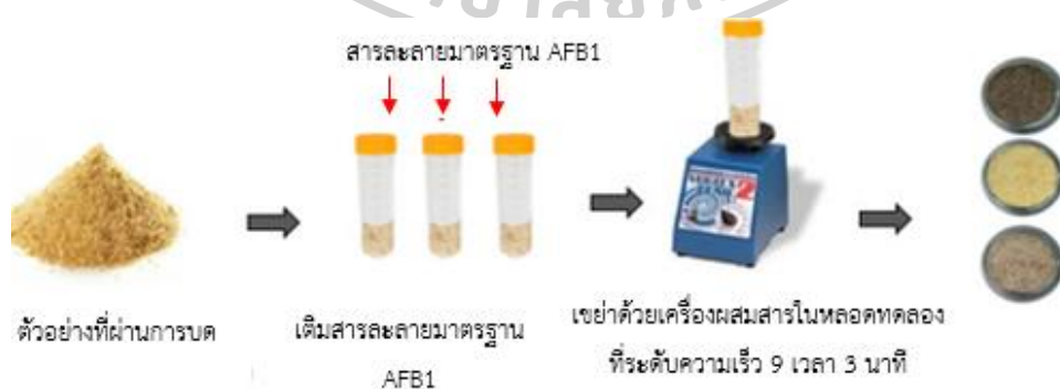
ภาพที่ 18 แผนภาพขั้นตอนการเตรียมตัวอย่างข้าวโพด พริกไทยและถั่วลิสงให้มีการปนเปื้อน AFB1
