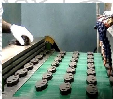
ภาพที่ 21 รูปแบบการวางชิ้นงานเข้าเครื่องพ่นสีแนวอน
