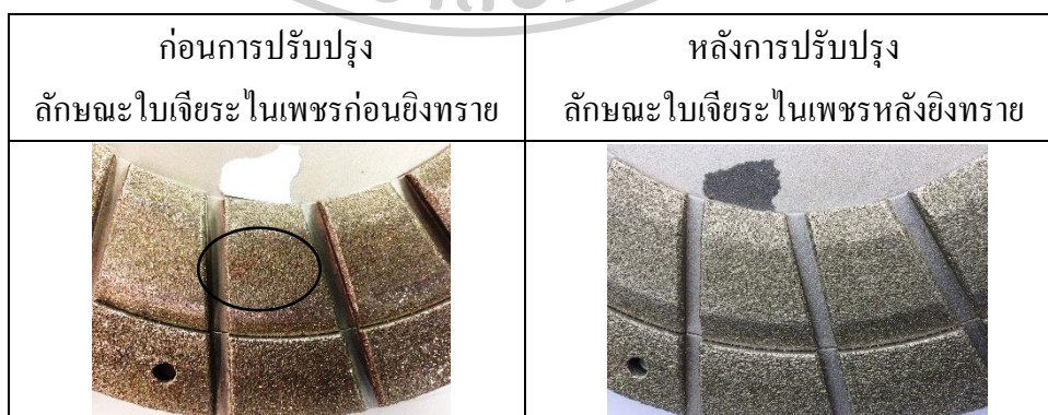
ภาพที่ 20 ภาพก่อนและหลังการปรับปรุงการยิงทรายใบเจียรไนเพชร
