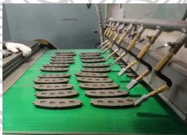
ภาพที่ 22 รูปแบบการวางชิ้นงานเข้าเครื่องฟันสีแนวตั้ง
