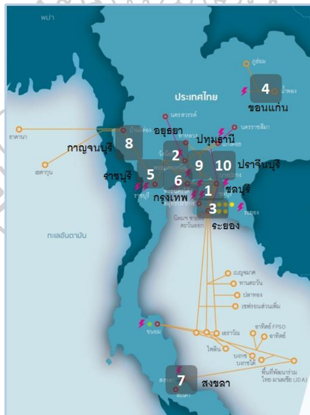
รูปที่ 6 ขอบเขตความรับผิดชอบของการดำเนินงานระบบท่อส่งก๊าซธรรมชาติ
