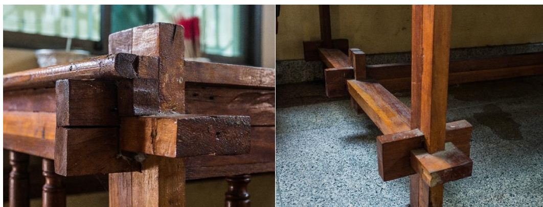
รูปที่ 143: ภาพรายละเอียดรอยต่อของโต๊ะในส่วนผิวหน้าโต๊ะ(ซ้าย) และขาโต๊ะ (ขวา)
