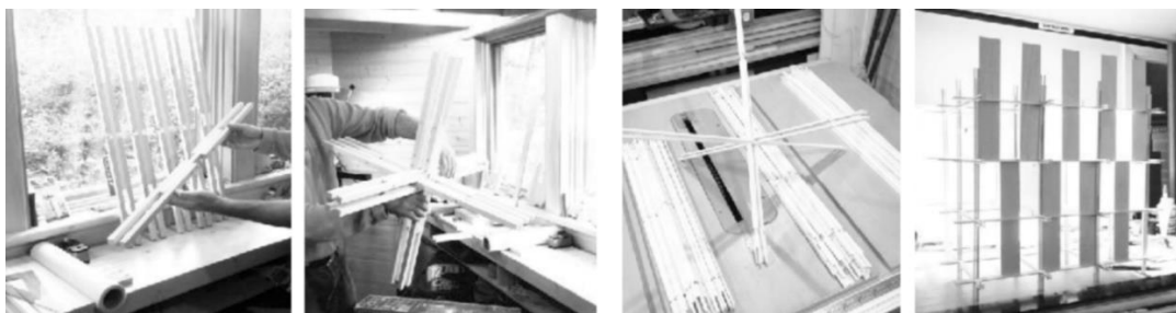
รูปที่ 93: แสดงหุ่นจำลองที่สร้างขึ้นเพื่อทดลองระบบการทำงานของโครงสร้าง
