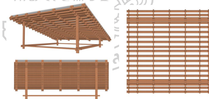
รูปที่ 214: หลังคาแบบไม่มีองศาแบบมีเถรอดเพลเป็นโครงสร้างทั้งหมด
