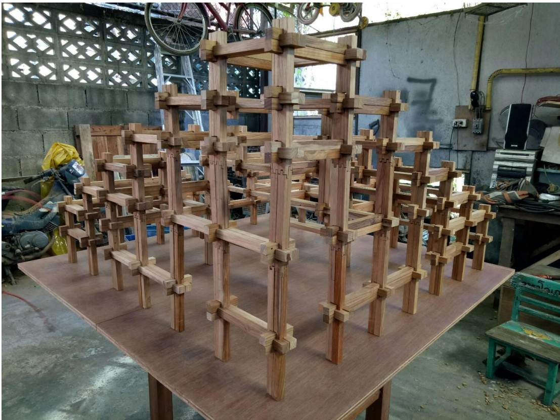
รูปที่ 100: หุ่นจำลองศาลาจากไม้สักที่แสดงแนวคิดเรื่องระยะ หน้าตัด และความยาวของชิ้นไม้
