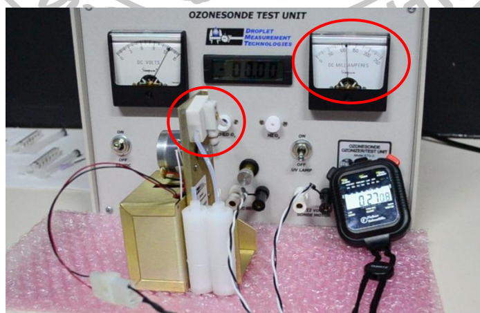
รูปที่ 3.50 วิธีการหาค่ากระแสไฟฟ้าของปั๊มของ ozonesonde
