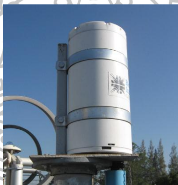
รูปที่ 3.11 เครื่องวัดรังสีอัลตราไวโอเล็ตแบบหลายช่องสัญญาณ รุ่น GUV-2511 ผลิตโดยบริษัท Biospherical Instrument GUV-2511 ซึ่งติดตั้งที่ศูนย์อุตุนิยมวิทยาภาคเหนือ จังหวัดเชียงใหม่ (18.78°N, 98.98°E)
