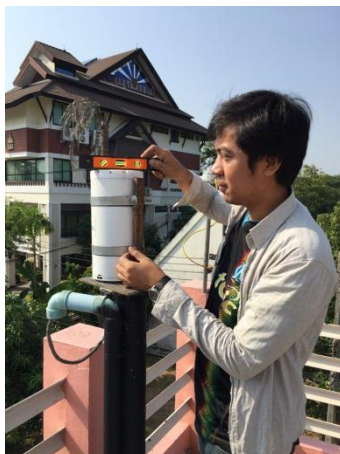
รูปที่ 3.14 การตรวจวัดระดับน้ำของเครื่องวัด GUV-2511 ที่สถานีเชียงใหม่เมื่อวันที่ 12 พฤษภาคม 2015
