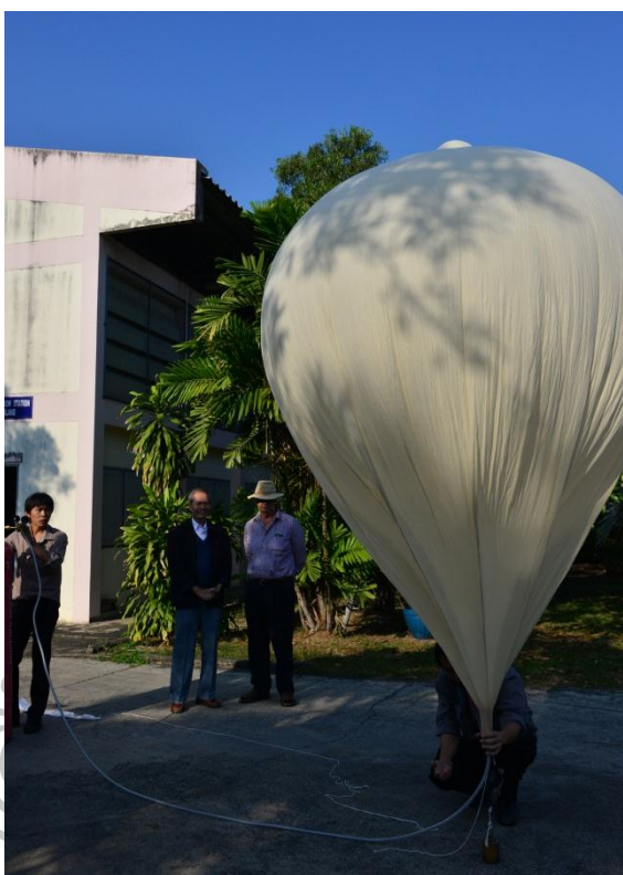
รูปที่ 3.54 การอัดก๊าซฮีเลียมเข้าไปในบอลลูนขนาด 1,600 กรัม ที่กรมอุตุนิยมวิทยา บางนา
