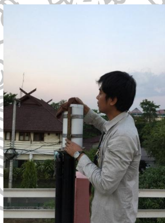
รูปที่ 3.15 การเช็ดทำความสะอาดหัววัดรังสีของเครื่องวัด GUV-2511 ที่สถานีเชียงใหม่เมื่อวันที่ 12 พฤษภาคม 2015
