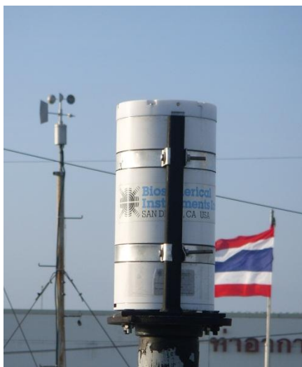
รูปที่ 3.25 เครื่องวัดรังสีอัลตราไวโอเล็ตแบบหลายช่องสัญญาณ รุ่น GUV-2511 ซึ่งติดตั้งที่ศูนย์อุตุนิยม-วิทยาภาคตะวันออกเฉียงเหนือตอนล่าง จังหวัดอุบลราชธานี (15.25°N, 104.87°E)
