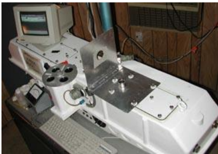
รูปที่ 3.28 Dobson Spectrophotometer ของกรมอุตุนิยมวิทยา ซึ่งติดตั้งที่สำนักงานใหญ่ของกรมอุตุนิยมวิทยา บางนา (13.67°N, 100.62°E) โดยเริ่มดำเนินการตรวจวัดตั้งแต่ปี 1979-ปัจจุบัน
