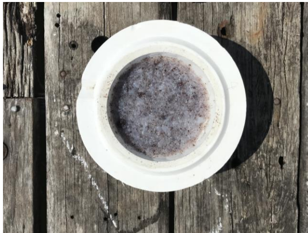
ภาพที่ 41 ฐานรูปฐานแบบปั้นผสมกับใยมะพร้าวขึ้นรูปด้วยแม่พิมพ์เซรามิก ที่มา : ผู้วิจัย, 5 มีนาคม 2562
