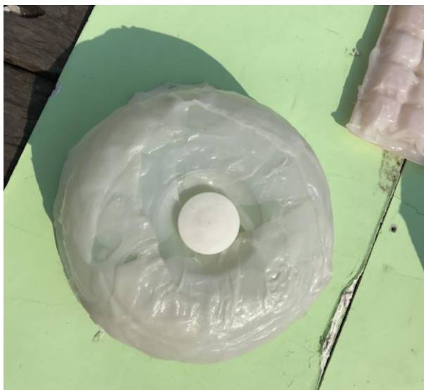
ภาพที่ 50 ขึ้นรูปฐานแบบแผ่นโดยการฝากรอบอาหาร
