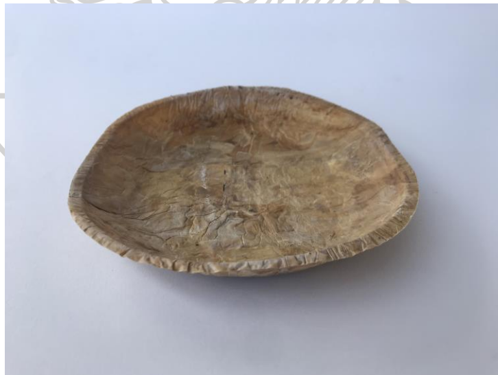
ภาพที่ 53 ขึ้นรูปวัสดุแบบแผ่นโดยการเข้าเครื่องอัดขึ้นรูป
