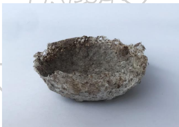
ภาพที่ 41 ฐานรูปฐานแบบปั้นผสมกับใยมะพร้าวขึ้นรูปด้วยแม่พิมพ์เซรามิก ที่มา : ผู้วิจัย, 5 มีนาคม 2562
