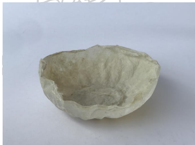
ภาพที่ 44 ขึ้นรูปฐานแบบปั้นผสมกับกากมะพร้าวขึ้นรูปด้วยแม่พิมพ์เซรามิก ที่แห้งแล้ว ที่มา : ผู้วิจัย, 11 กุมภาพันธ์ 2562
