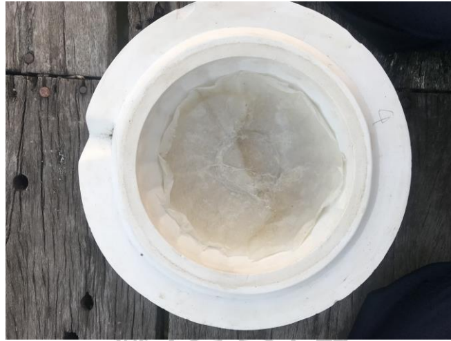
ภาพที่ 43 ขึ้นรูปฐานแบบปั้นผสมกับกากมะพร้าวขึ้นรูปด้วยแม่พิมพ์เซรามิก ที่มา : ผู้วิจัย, 11 กุมภาพันธ์ 2562
