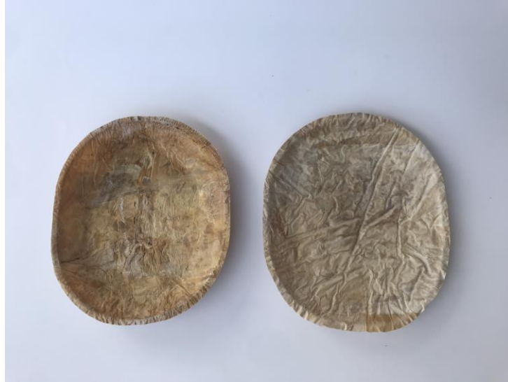
ภาพที่ 52 ขึ้นรูปวัสดุแบบแผ่นโดยการเข้าเครื่องอัดขึ้นรูป
