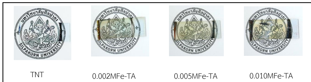
ภาพที่ 39 ภาพถ่ายฟิล์มบางไทเทเนียมไดออกไซด์ที่ดูดซับสารประกอบเชิงซ้อน Fe-tannic acid ที่ความเข้มข้นต่าง ๆ
