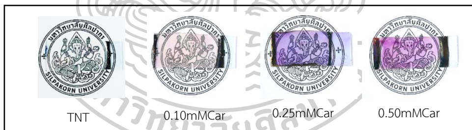
ภาพที่ 33 ภาพถ่ายฟิล์มบางไทเทเนียมไดออกไซด์ที่ดูดซับสีย้อมกรดคาร์มินิกที่ความเข้มข้นต่าง ๆ
