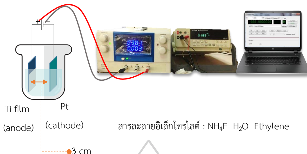
ภาพที่ 21 กระบวนการเตรียมฟอนาโนไทเทเนียมไดออกไซด์ด้วยวิธีแอโนไดเซชัน
