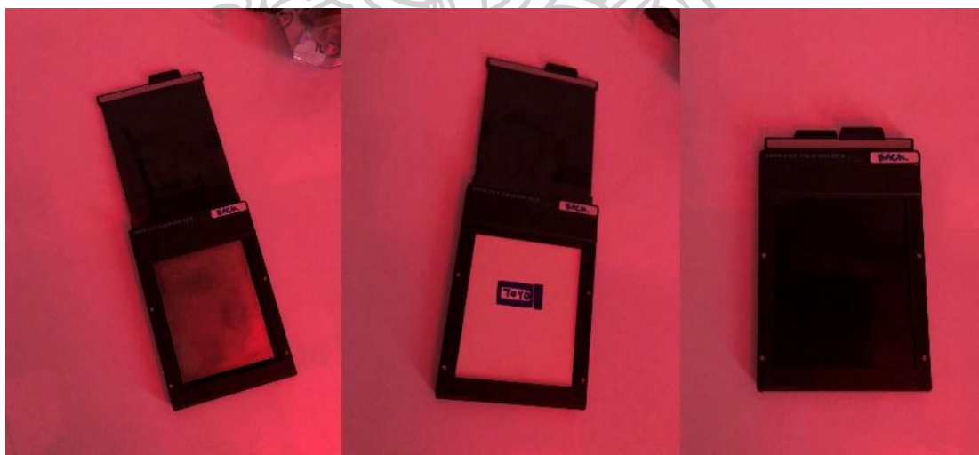
ภาพที่ 54 ขั้นตอนการบรรจุแผ่นไวแสงลงในเพลทโฮลเดอร์ หมายเลข 1
