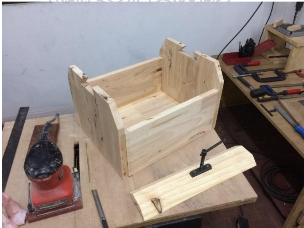
ภาพที่ 23 ขั้นตอนการสร้างกล่องรมสาร (Sensitizing boxes) หมายเลข 2
