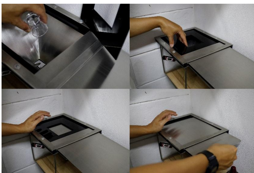
ภาพที่ 57 ขั้นตอนการสร้างภาพ (Development) ด้วยระบบตาแกโรไทป์ หมายเลข 1
