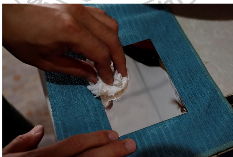
ภาพที่ 49 ขั้นตอนการล้างทำความสะอาดคราบมันที่เกิดจากยาขัดเงา หมายเลข 2
