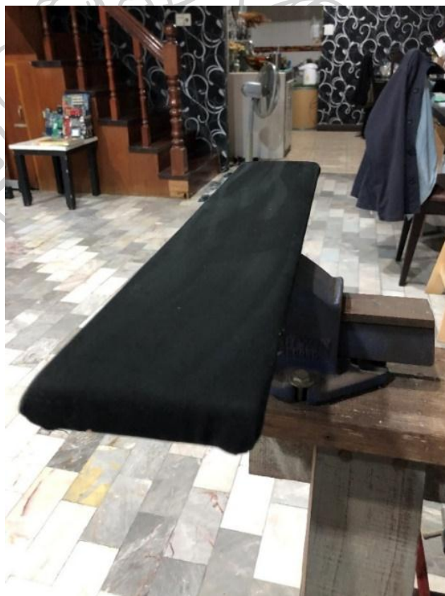
ภาพที่ 28 ด้ามกำหยาสำหรับขัดผิวเพลทโลหะ (Hand polishing) หมายเลข 3
