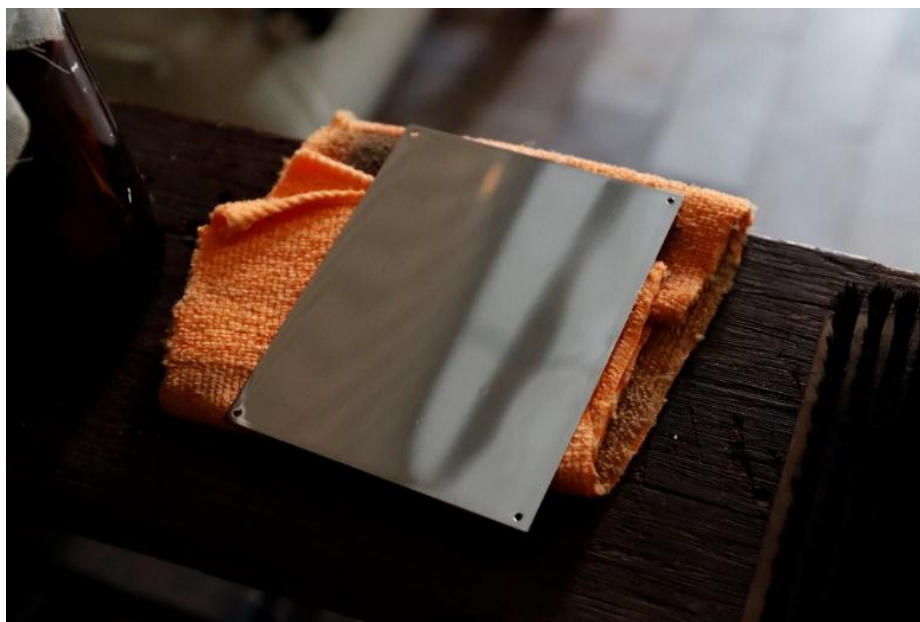
ภาพที่ 51 เพลทโลหะที่ผ่านขั้นตอนการขัดเงาด้วยด้ามกำมะหยี่ และผงไอรอนออกไซด์
