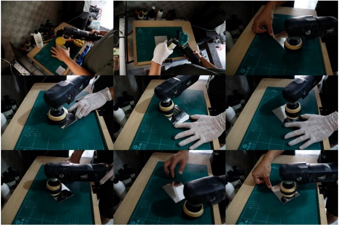
ภาพที่ 46 ขั้นตอนการขัดเงาเพลทโลหะด้วยเครื่องขัดเงา
