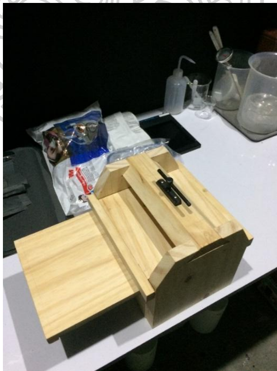
ภาพที่ 25 ขั้นตอนการสร้างกล่องรมสาร (Sensitizing boxes) หมายเลข 4
