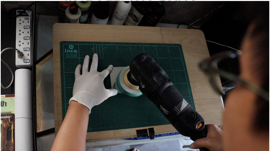
ภาพที่ 47 ขั้นตอนการขัดเงาเพลทโลหะด้วยเครื่องขัดเงา และยาขัดเงา
