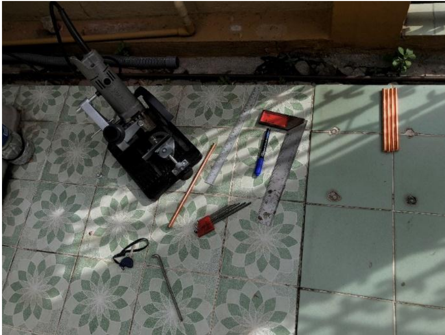
ภาพที่ 37 ขั้นตอนการเตรียมอุปกรณ์สำหรับการชุบไฟฟ้า (Electroplating) หมายเลข 1
