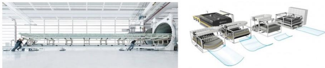
Fig 4. 43 ขนาดของเครื่องจักรในการตัดโค้งกระจกใส
