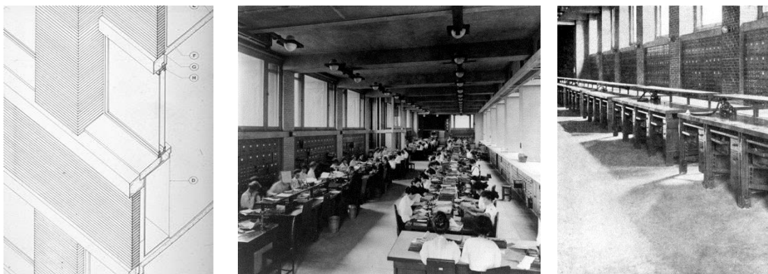
Fig 3. 45 รูปตัดขยายผนังอาคารแสดงพื้นที่ชั้นวางของและหน้าต่าง
