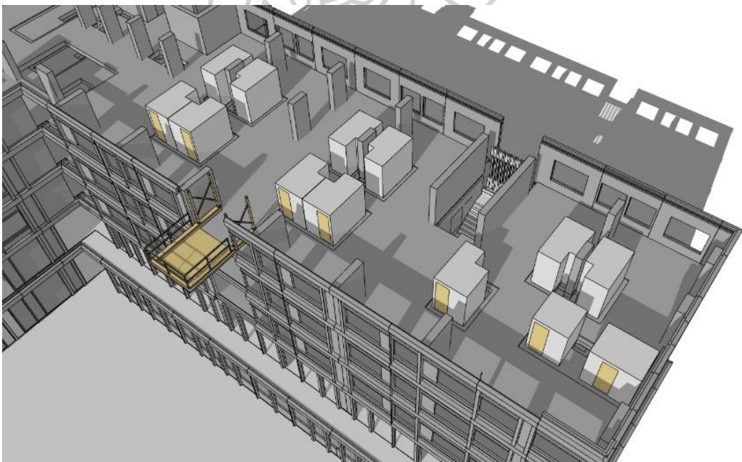
รูปภาพที่ 25 การติดตั้ง ห้องน้ำประเภทที่ 1 : งานวางห้องน้ำสำเร็จรูปทุกหน่วยในชั้นลงยังพื้นที่ติดตั้ง และทดสอบการระบายน้ำ
