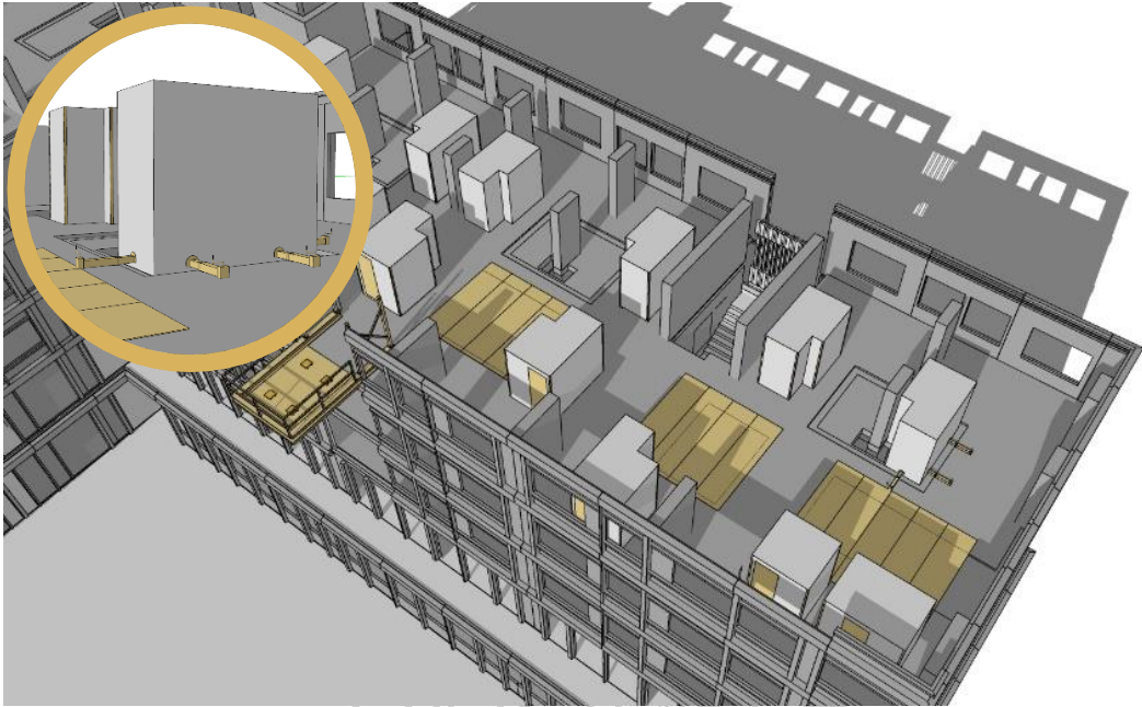
รูปภาพที่ 24 การติดตั้ง ห้องน้ำประเภทที่ 1 : งานปรับระดับพื้นห้องน้ำสำเร็จรูปโดยการใช้แผ่นยาง และเหล็กแผ่น
