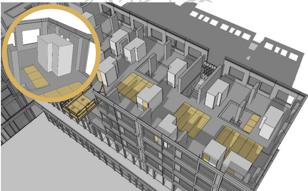
รูปภาพที่ 23 การติดตั้ง ห้องน้ำประเภทที่ 1 : งานจัดเตรียมตัวปรับระดับและทำทางลาดสำหรับการ เข็นห้องน้ำไปยังพื้นที่ติดตั้ง
