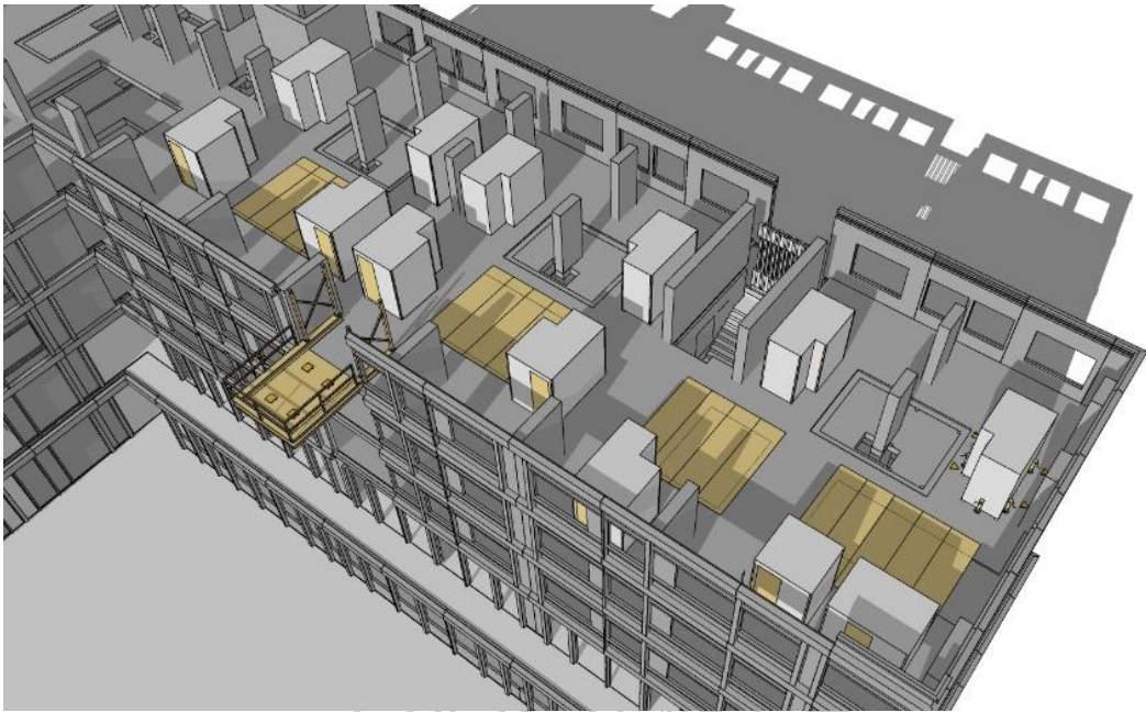
รูปภาพที่ 22 การติดตั้ง ห้องน้ำประเภทที่ 1 : งานวางห้องน้ำทั้งหมดใกล้เคียงพื้นที่ติดตั้ง
