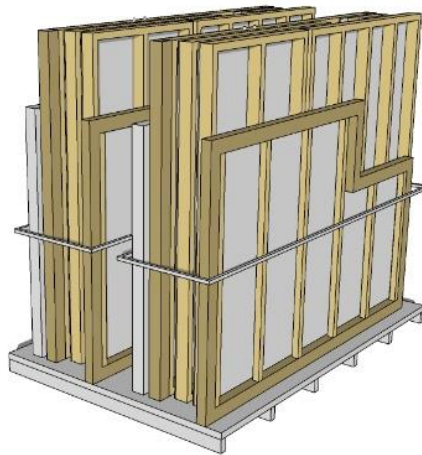
รูปภาพที่ 42 การผลิตในโรงงาน ห้องน้ำประเภทที่ 3 : งานจัดเตรียมลวดพลาเทเพื่อขนไปยังพื้นที่โครงการ
