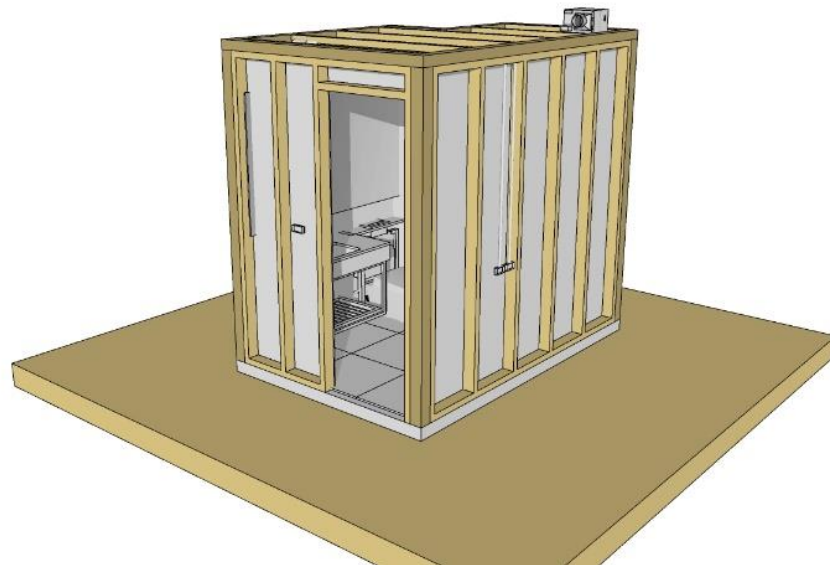
รูปภาพที่ 49 การติดตั้ง ห้องน้ำประเภทที่ 3 : งานแล้วเสร็จเตรียมต่องานระบบไฟฟ้าและประปา
