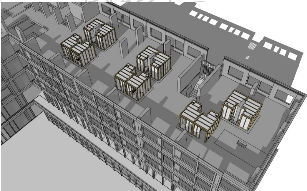
รูปภาพที่ 39 การติดตั้ง ห้องน้ำประเภทที่ 2 : งานจัดเรียงห้องน้ำในแนวระนาบไปยังพื้นที่ติดตั้ง
