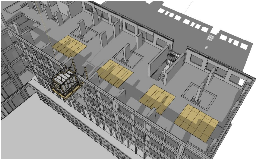
รูปภาพที่ 38 การติดตั้ง ห้องน้ำประเภทที่ 2 : งานวางห้องน้ำสำเร็จรูปบนพื้นที่รองรับวัสดุ อุปกรณ์ ก่อสร้าง
