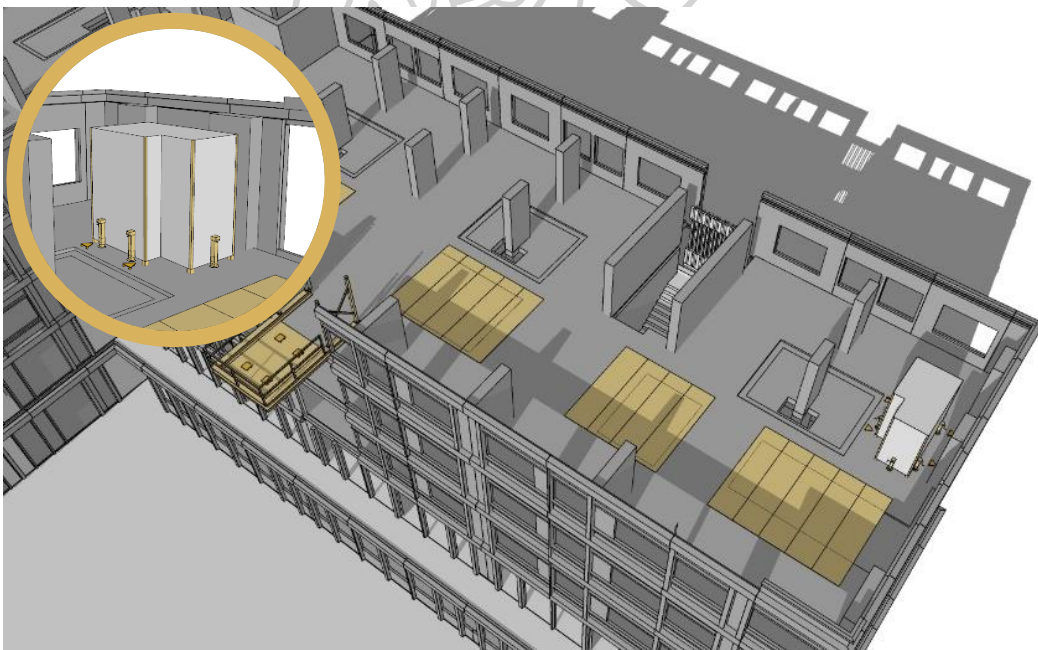
รูปภาพที่ 21 การติดตั้ง ห้องน้ำประเภทที่ 1 : งานถอดล้อเลื่อนและแม่แรงออกจากห้องน้ำ
