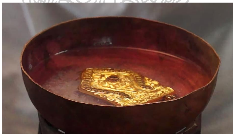
รูปที่ 96 นำชิ้นงานแช่น้ำกรดอย่างเจือจาง
