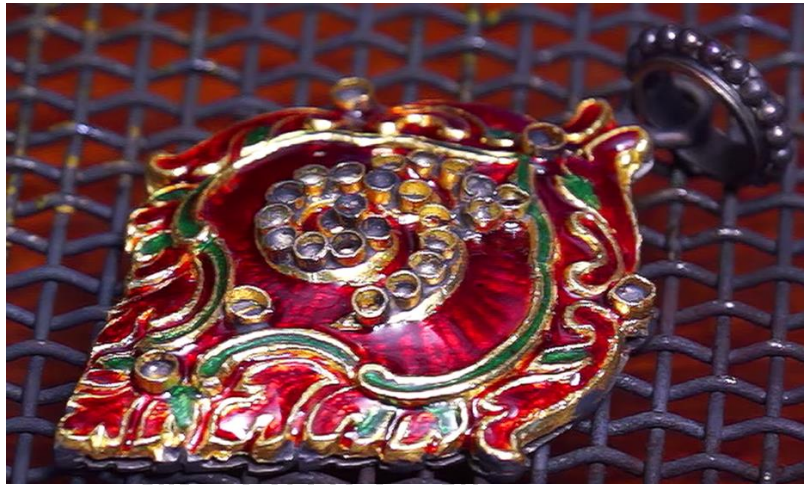
รูปที่ 103 เป้าชิ้นงานให้แห้งเพื่อขจัดไขมัน ที่มา : รายการร้อยเรื่องเมืองไทย ตอน เครื่องลงยา ออกอากาศเมื่อวันที่ 8 มี.ค. 58 สืบค้นเมื่อ 12 ธ.ค. 62
