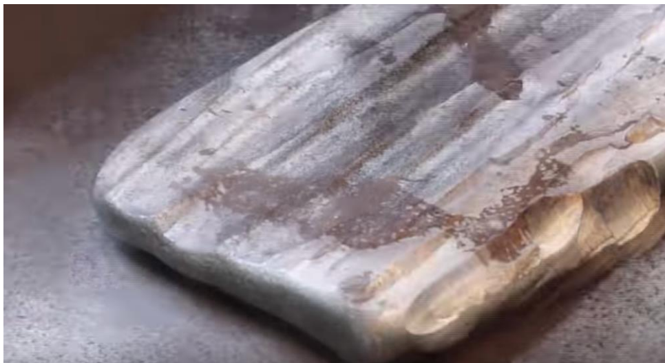
รูปที่ 113 ทูบแผ่นเงินที่ผสมน้ำประสานแล้ว ด้วยพะเนินเพื่อขึ้นรูปเป็นชิ้นงาน ที่มา: รายการกระจกหกด้าน ออกอากาศวันที่ 16 ก.ย.57 สืบค้นเมื่อสืบค้นเมื่อ 12 ธ.ค. 62
