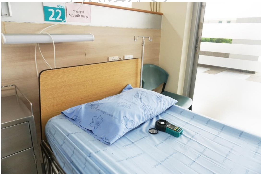
ภาพที่ 8 แสดงตัวอย่างผังการวัดแสง A คือตำแหน่งการวางเครื่องวัดแสงระดับสายตาผู้ป่วย (ภาพโดย กาญจนา เลาหรัชธานีรินทร์)
