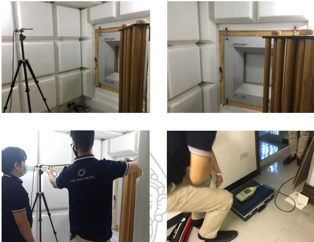
ภาพที่ 16 ภาพการทดสอบชิ้นงานด้านเสียงกลองดนตรีที่บริษัท NOE Asia Pacific. (ภาพโดย กาญจนา เล่ห์รัชชานินทร์)
