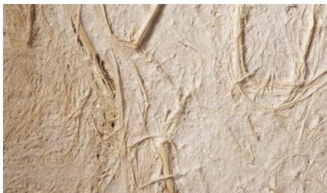
ภาพที่ 45 ภาพกระดาษใบอ้อย ที่ตัดเส้นใยหนาแน่นมาก (ฟอกสี) (ที่มา: วิชชุดา พิมพ์เจริญ, 2563)
