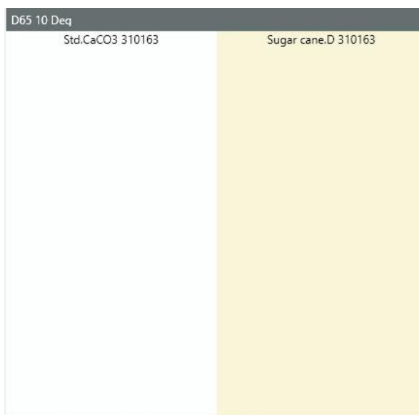
ภาพที่ 31 ภาพแสดงผลการเทียบค่าสีที่เปลี่ยนไปของใบอ้อยแห้งผสม \text{CaCO}_3 กับสีของ \text{CaCO}_3 (ที่มา: วิชชุดา พิมพ์เจริญ, 2563)
