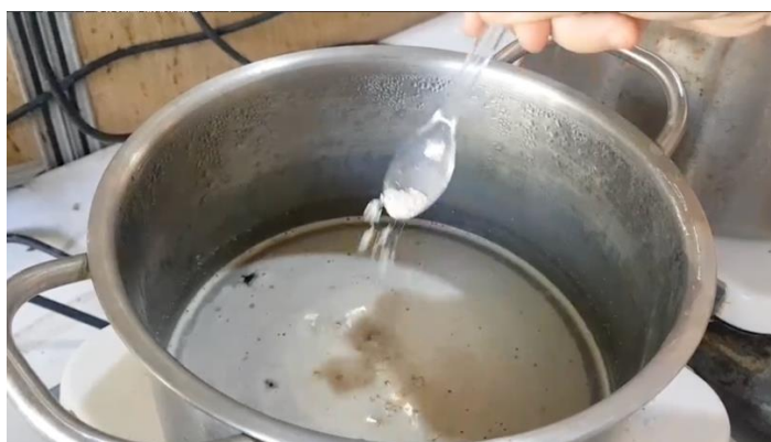
ภาพที่ 21 ภาพแสดงวิธีการต้มใส่สารจับสี (ที่มา: วิชชุดา พิมพ์เจริญ, 2563)
