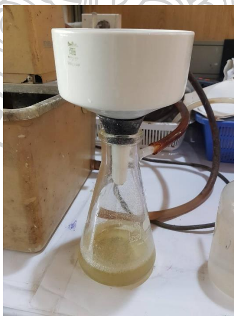
ภาพที่ 24 ภาพการใช้เครื่อง Suction กรองการจับสีใบอ้อย (ที่มา: วิชชุดา พิมพ์เจริญ, 2563)
