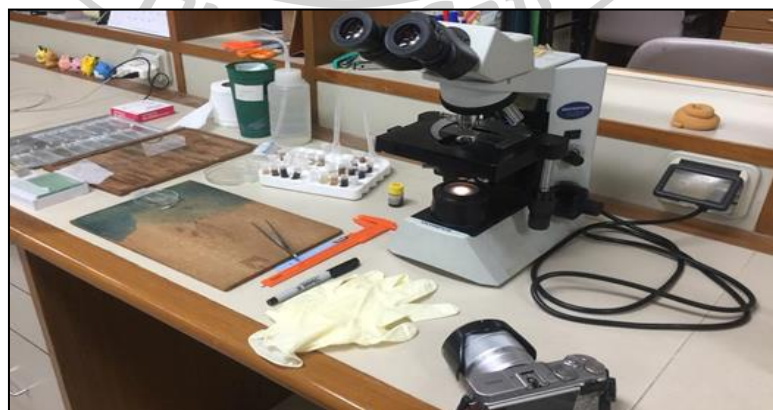
ภาพที่ 21 ถ่ายรูป cephalopharyngeal skeleton ภายใต้กล้องจุลทรรศน์แบบใช้แสงติดกับ กล้องดิจิทัลที่กำลังขยาย 40X เท่า จำนวน 400 ภาพ
