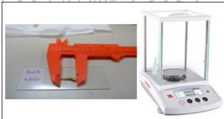
ภาพที่ 18 วัดขนาดความยาวของหนอนแต่ละตัวโดยใช้เวอร์เนียคาลิเปอร์ และชั่งน้ำหนัก
