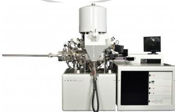
รูปที่ 7 เครื่องวิเคราะห์พื้นผิววัสดุ (X-ray Photoelectron Spectroscopy; XPS) (ยี่ห้อ Khatos analytical รุ่น AXIS Ultra DLD, อังกฤษ)
