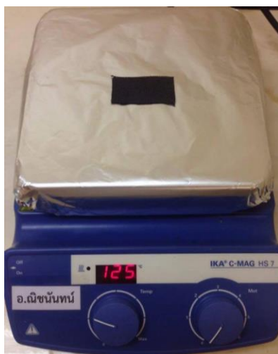
รูปที่ 22 การวางผ้าคาร์บอนที่ถูกพันเคลือบด้วย Pt/MWCNTs-COOH บน Hot plate เพื่อให้สารแขวนลอย Pt/MWCNTs-COOH แห้ง และเกาะบนผ้าคาร์บอน
