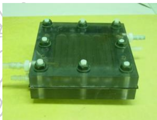
รูปที่ 6 เซลล์เชื้อเพลิงจุลชีพแบบช่องเดี่ยวแบบแบน (Min & Logan, 2004)
