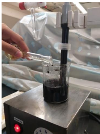
รูปที่ 13 การเทสารละลาย \text{H}_2\text{PtCl}_6 \cdot 6\text{H}_2\text{O} 25.00 mL ลงในสารแขวนลอย MWCNTs-COOH
