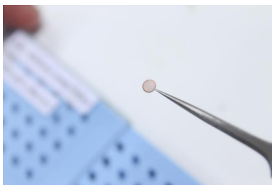
รูปที่ 10 Copper grid (ยี่ห้อ EMS รุ่น FCF 300-Cu, สหรัฐอเมริกา)
