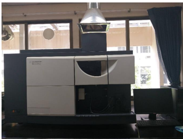
รูปที่ 8 Inductively Coupled Plasma-Optical Emission Spectrometer; ICP-OES (ยี่ห้อ Agilent รุ่น 710 ICP-OES, สหรัฐอเมริกา)
