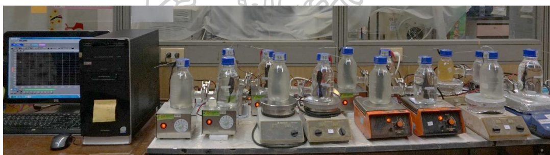
รูปที่ 23 การต่อเซลล์เชื้อเพลิงจุลชีพเข้ากับ Data logger พร้อมการแสดงผลบนหน้าจอ Computer
