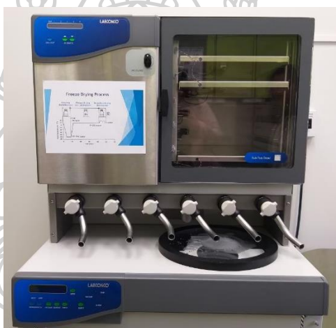
รูปที่ 6 เครื่องทำแห้งแบบแช่เยือกแข็ง (Freeze dryer) (ยี่ห้อ Labconco รุ่น 78060 series, สหรัฐอเมริกา)
