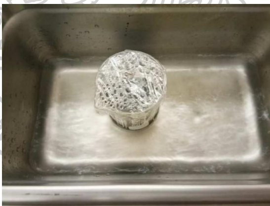
รูปที่ 12 การทำให้ MWCNTs-COOH กระจายตัวใน 1% (v/v) Triton X-100 เป็นเวลา 90 นาที ด้วย Sonicator bath
