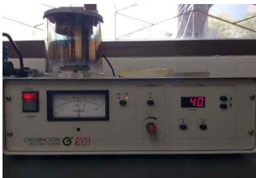
รูปที่ 5 เครื่องเคลือบตัวอย่าง (Sputter coater) (ยี่ห้อ Cressington รุ่น sputter coater 108, อังกฤษ)
