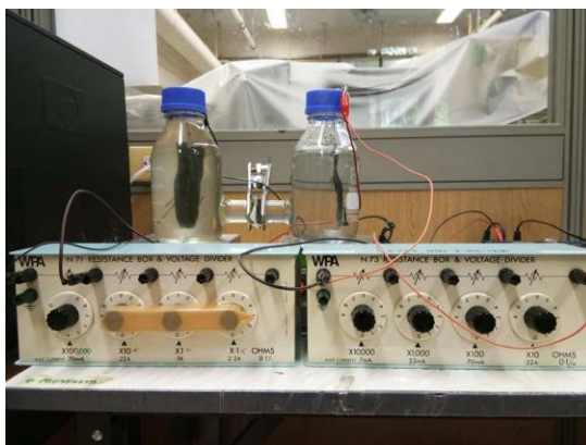
รูปที่ 11 การต่อเซลล์เชื้อเพลิงจุลชีพเข้ากับ Resistance box เพื่อสร้าง Polarization curve และ Power density curve
