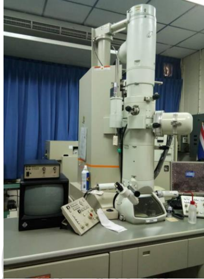
รูปที่ 1 กล้องจุลทรรศน์อิเล็กตรอนแบบส่องผ่าน (Transmission Electron Microscope; TEM) (ยี่ห้อ JEOL รุ่น JEM-2100, ญี่ปุ่น)
