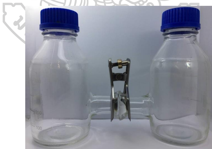
รูปที่ 4 เซลล์เชื้อเพลิงจุลชีพแบบช่องคู่รูปตัว H
