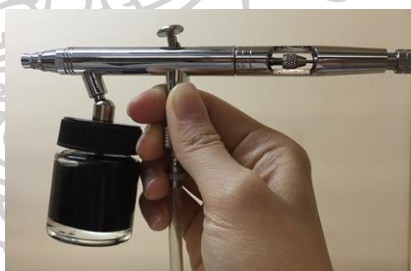
รูปที่ 20 อุปกรณ์การพ่นเคลือบสารแขวนลอย Pt/MWCNTs-COOH
