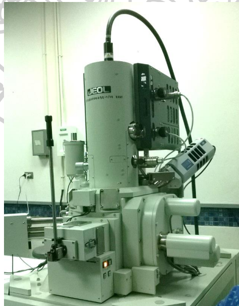
รูปที่ 2 กล้องจุลทรรศน์อิเล็กตรอนแบบส่องกราดชนิดฟิลด์อิมิสชัน (Field Emission Scanning Electron Microscope) (ยี่ห้อ JEOL รุ่น JSM 7610F, ญี่ปุ่น)
