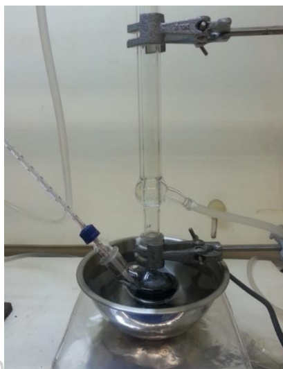
รูปที่ 19 การจัดอุปกรณ์สำหรับการรีฟลักซ์สารแขวนลอย Pt/SWCNTs-COOH ที่อุณหภูมิ 80 °C เป็นเวลา 60 นาที
