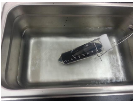
รูปที่ 16 การทำให้ SWCNTs-COOH กระจายตัวในน้ำ DI เป็นเวลา 60 นาที ด้วย Sonicator bath
