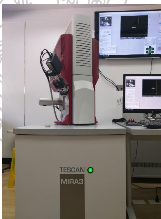
รูปที่ 4 กล้องจุลทรรศน์อิเล็กตรอนแบบส่องกราดชนิดฟิลด์อิมิสชัน ร่วมกับเครื่องเอ็กซ์เรย์แบบพลังงานกระจาย (Field Emission Scanning Electron Microscope-Energy Dispersive X-ray Spectroscopy; FESEM-EDX) (ยี่ห้อ TESCAN รุ่น MIRA3, สาธารณรัฐเช็ก)
