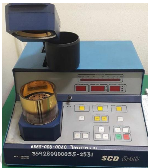
รูปที่ 3 เครื่องเคลือบตัวอย่าง (Sputter coater) (ยี่ห้อ Balzers รุ่น SCD 040, ลิกเตนสไตน์)
