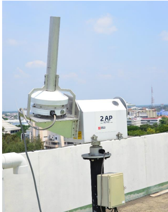
รูปที่ 3.12 เครื่องวัดสเปกตรัมรังสีอาทิตย์ EKO spectroradiometer รุ่น MS-710 ที่มีการติดตั้งบังคับแสงด้านบนไปติดตั้งบนเครื่องติดตามตำแหน่งดวงอาทิตย์เพื่อวัดสเปกตรัมรังสีตรงจากดวงอาทิตย์
