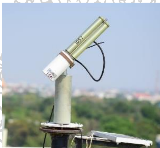
รูปที่ 3.55 เครื่อง cimel sunphotometer ที่ติดตั้งอยู่ที่สถานีวัดภาคพื้นดินที่จังหวัดนครปฐม
