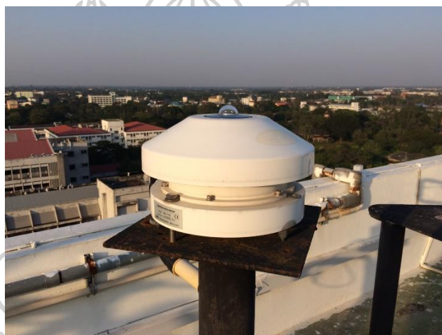
รูปที่ 3. 74 เครื่อง spectroradiometer รุ่น MS -710 ของบริษัท EKO ที่ติดตั้งอยู่ในมหาวิทยาลัยศิลปากร จังหวัดนครปฐม
