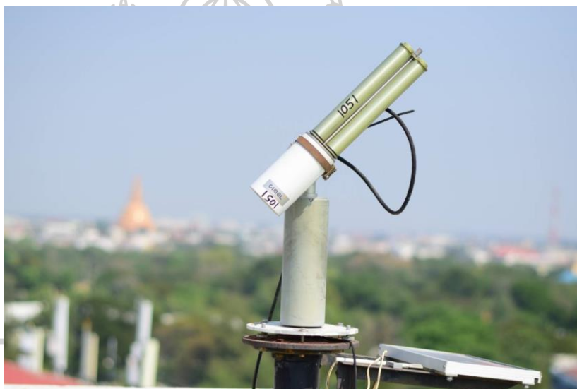
รูปที่ 3.3 เครื่อง cimel sunphotometer
