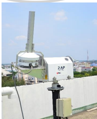
รูปที่ 2.13 เครื่องวัดสเปกตรัมรังสีอาทิตย์ที่มีการติดท่อบังคับแสงด้านบนไปติดตั้งบนเครื่องติดตามตำแหน่งดวงอาทิตย์ (sun tracker)
