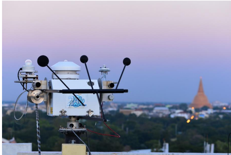
รูปที่ 2.15 เครื่องวัดสเปกตรัมรังสีกระจายที่มีลูกบอลบังรังสีตรงที่ติดอยู่กับเครื่องติดตามตำแหน่งดวงอาทิตย์ (Sun tracker)
