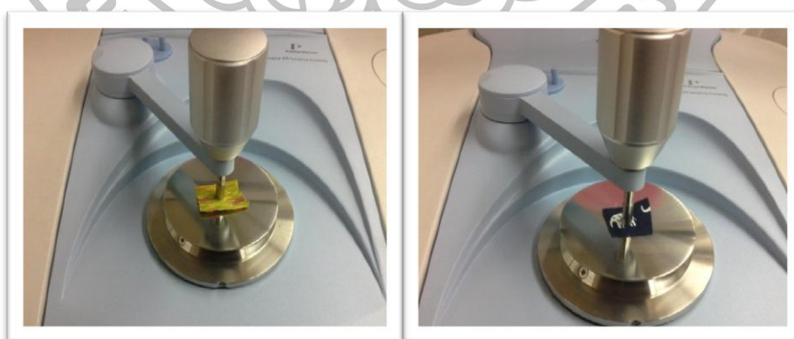
รูปที่ 3.4 การวิเคราะห์ผ้าแต่ละชนิดด้วยเทคนิค Attenuated Total Reflection Fourier Transform Infrared Spectroscopy (ATR-FTIR)
