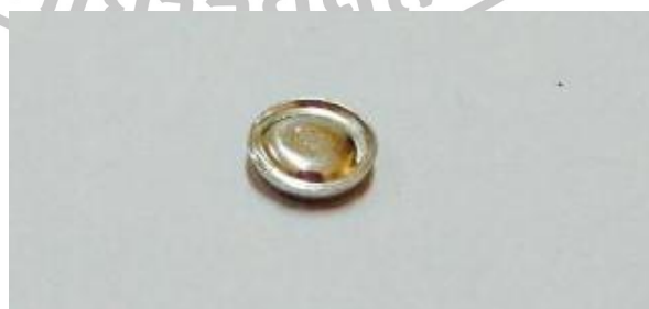
รูปที่ 10 แสดง pan ใสตัวอย่างของเครื่อง DSC
