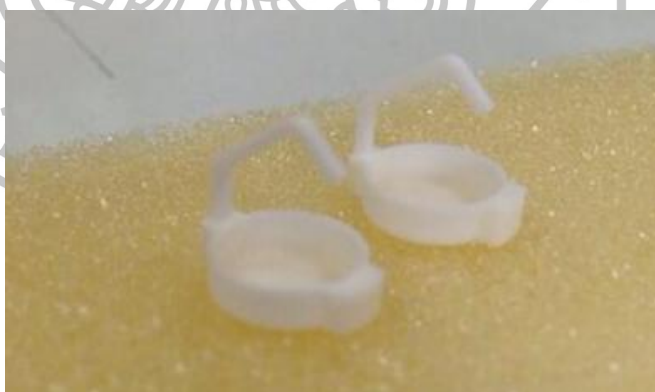
รูปที่ 9 แสดง crucible สำหรับใส่ตัวอย่าง เครื่อง TGA
