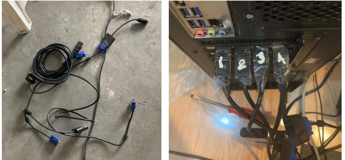
ภาพที่ 31 ภาพอุปกรณ์แปลงสัญญาณจากคอมพิวเตอร์สู่จอภาพ ประกอบด้วยสาย HDMI จำนวน 2 เส้น DP PORT จำนวน 2 เส้น และอุปกรณ์แปลงสัญญาณสู่สาย VGA 4 ตัวแปลง
