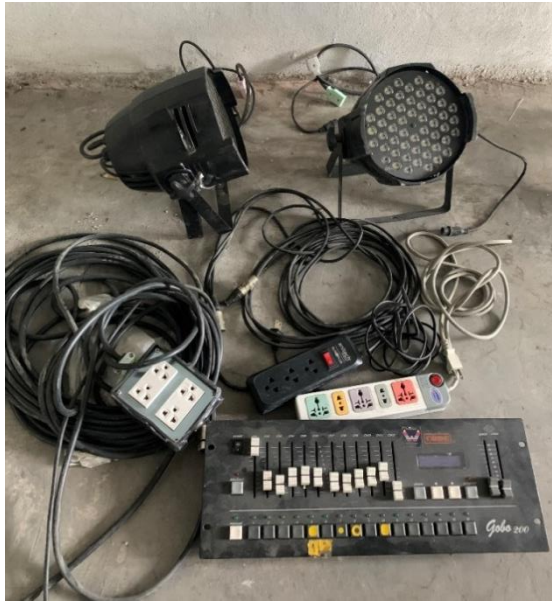
ภาพที่ 47 อุปกรณ์ให้แสงสว่าง ชนิดสปอร์ตไลท์ LED 2 ดวง สายสำหรับเชื่อมต่อดวงโคม แล้วอุปกรณ์เพิ่มเติมตัวรับ 3 ชุด เมนบอร์ด ควบคุมแสง สี และจังหวะการกระพริบของดวงโคม
