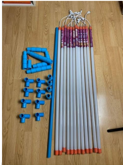
ภาพที่ 76 ทำการออกแบบกล่องไฟ LED จากหลอดไฟ และโครงจากท่อน้ำประปาและข้อต่อชนิดต่างๆไฟ LED ชนิดหลอด 80 W แสดงสีไฟเป็นสีแดง ขนาดเส้นผ่านศูนย์กลาง 2.5 เซนติเมตร ยาว 130 เซนติเมตร
