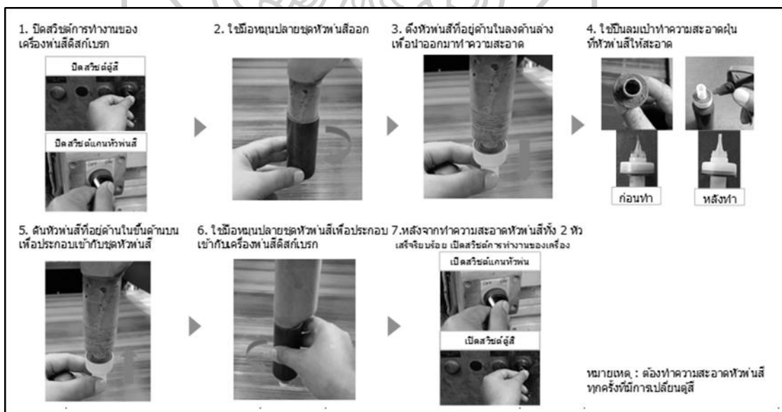
รูปที่ 37 Work Instructions (WI) การทำความสะอาดหัวพ่นสี
