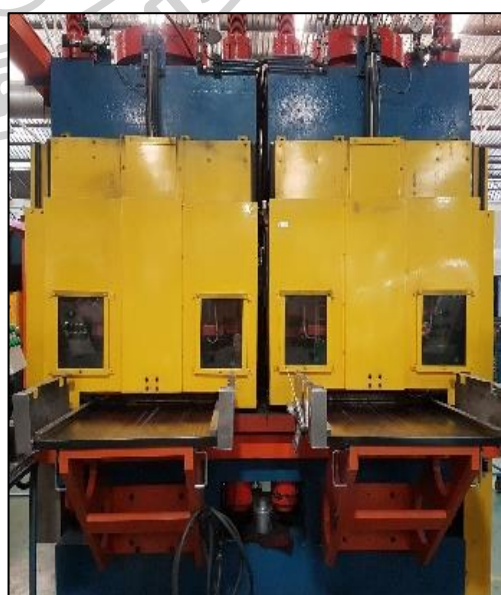
รูปที่ 5 เครื่องพิมพ์ร้อนประเภท Manual (ซ้าย) และเครื่องพิมพ์ร้อนประเภท Auto (ขวา)
