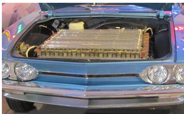
รูปที่ 2.9 แบตเตอรี่ของรถไฟฟ้าอิเล็กโตรแวร์
