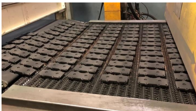
รูปที่ 13 ชิ้นงานออกจากเครื่องพ่นสีเข้าเครื่องอบสี
