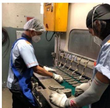
รูปที่ 12 พนักงานพ่นสีเรียงชิ้นงานบนสายพาน
