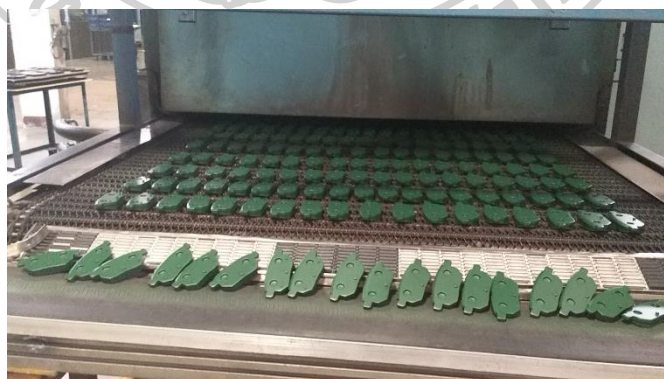
รูปที่ 14 แถวชิ้นงานเคลื่อนที่เข้าสายพานที่ 1 ของกระบวนการยิงรหัสผลิต
