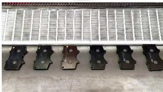
รูปที่ 36 วางแถวชิ้นงานบนสายพานที่ 1 ด้วย X_1 ตาราง
